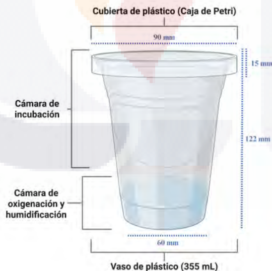
Figura 1. Esquema del recipiente de desarrollo artificial: dimensiones y partes del recipiente de incubación.
