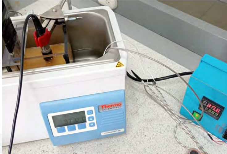
Figura 27. Puesta a punto del sistema de inspección US para caso tumoral con punto de calor inmerso.
