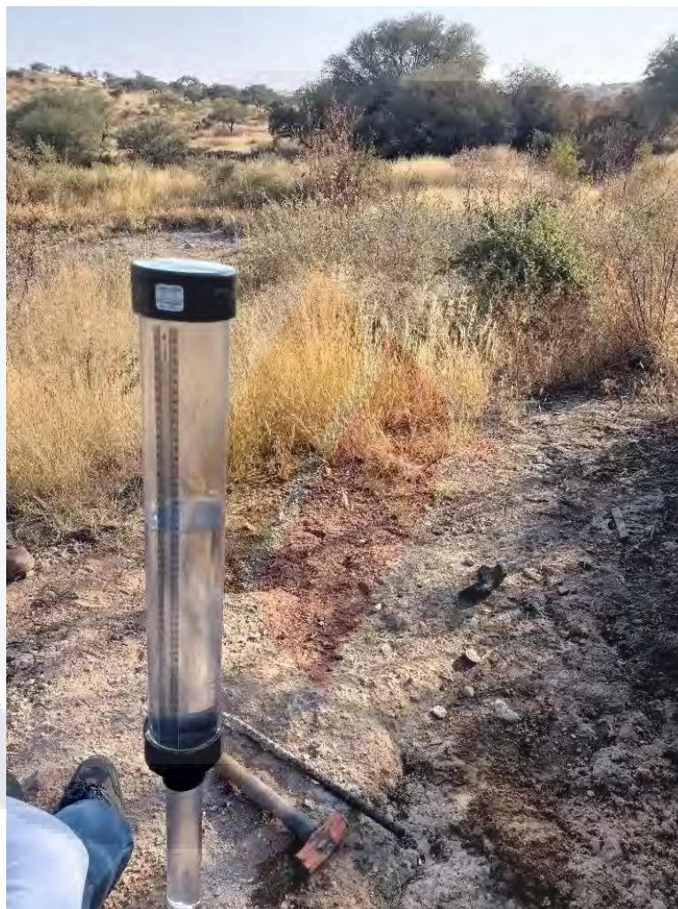
Figura 13. Permeámetro tipo Pask estándar durante una prueba de permeabilidad.
