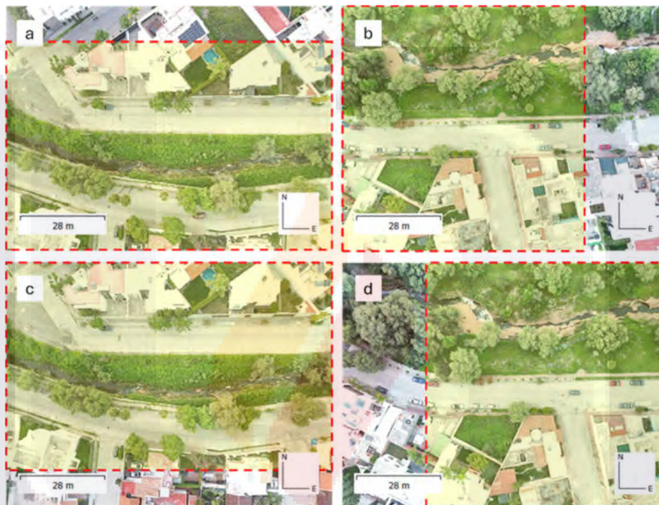
Figura 19. El recuadro rojo indica el grado de superposición frontal y lateral entre imágenes en el conjunto 2. Las figuras 3a y 3c muestran la superposición frontal (83 %), mientras que las figuras 3b y 3d muestran la superposición lateral (66 %).
