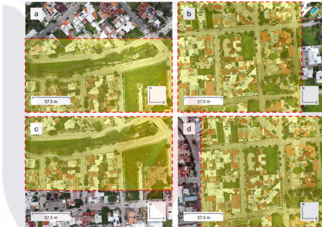
Figura 18. El recuadro rojo indica el grado de superposición frontal y lateral entre imágenes en el conjunto 1. Las figuras 3a y 3c muestran la superposición frontal de 66 %, mientras que las figuras 3b y 3d muestran la superposición lateral de 83 % (Tomado de Vizcaíno-López et al., 2025b).
