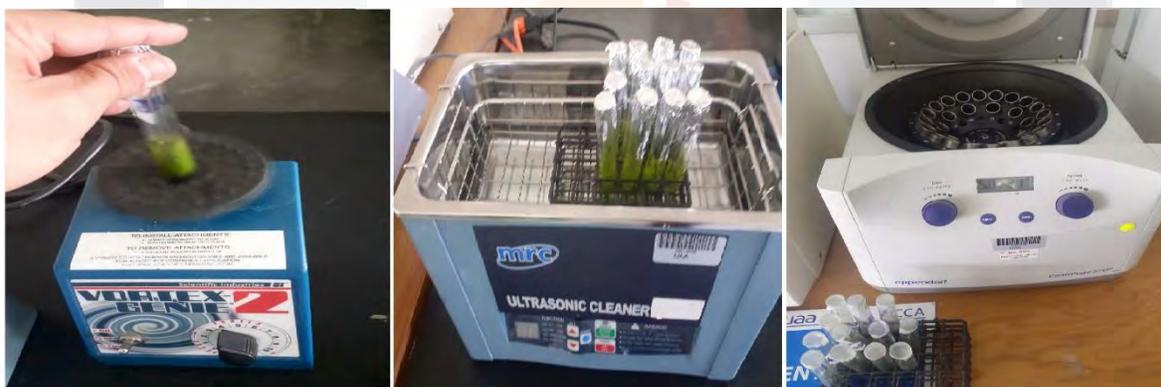
**Figura 21. Proceso de las muestras mediante agitación, sonicado y centrifugación.**
