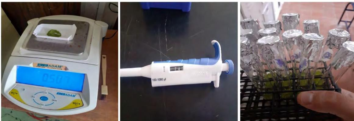
**Figura 20. Pesaje de material vegetal molido y preparación de mezcla con solvente.**
