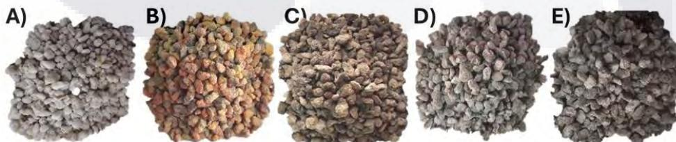
**Figura 11.** Perlitas impregnadas de material sintetizado. A) Perlita, B) BiOI@perlita, C) BiOI/GO@perlita, D) BiOCl@perlita y E) BiOCl/GO@perlita.
