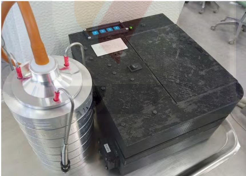
**Figura 40.** Muestra de prototipo del transporte público con el impactador de cascada de Andersen de seis niveles.
