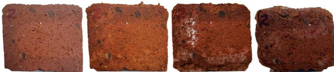
Ilustración 47 Representación de efectos de CCSS, muestras de ladrillo: ciclos 0, 2, 5, 8. E. propia.
