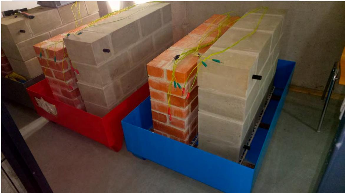
Ilustración 79 Inducir humedades en muros mediante recipientes de acero (Frenzel et al., 2023).
