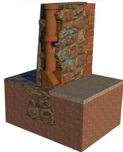
Ilustración 18 Humedad accidental, proviene de instalaciones dañadas. Elaboración propia.
