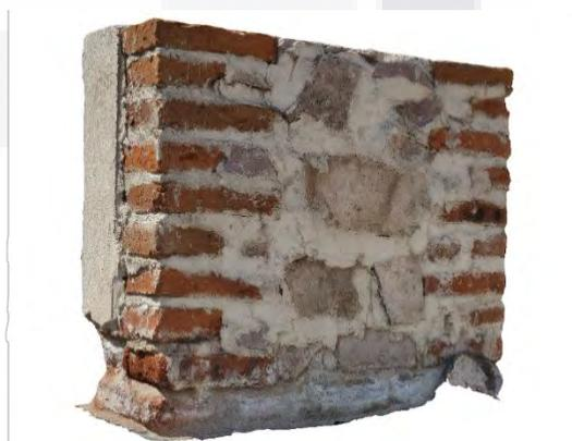
Ilustración 108 Similitud entre la degradación ubicada en los desplantes de elementos del templo y la degradación obtenida en laboratorio. Elaboración propia.
