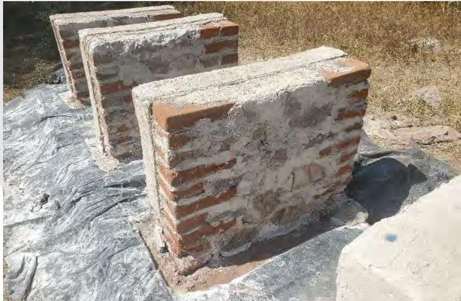
Ilustración 105 Residuos de materiales precipitados en la base de los especímenes. Elaboración propia.
