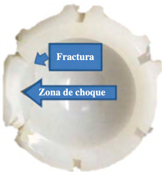
ILUSTRACIÓN 25. FALLA DE UHMWPE
