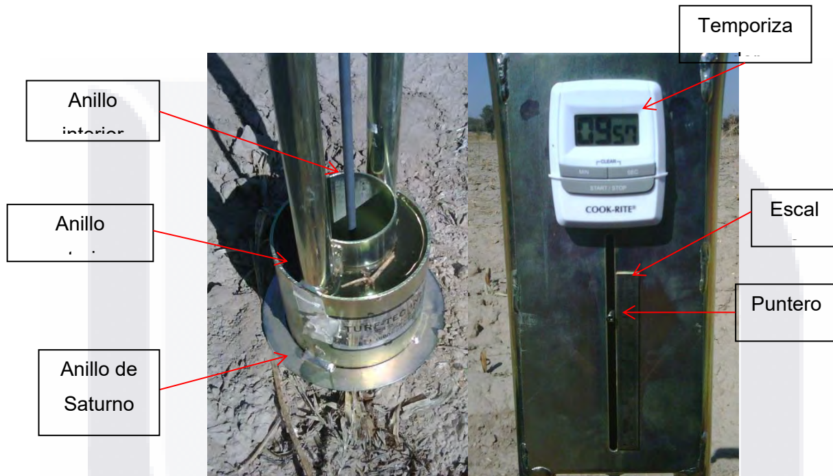
Figura 3.9 Imagen y partes del mini-infiltrómetro Turf-Tech
