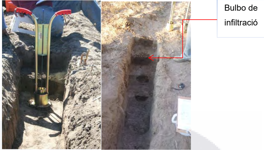
Figura 3.18. Perfiles de infiltración con mini-infiltrómetro Turf Tech® a cuatro profundidades.
