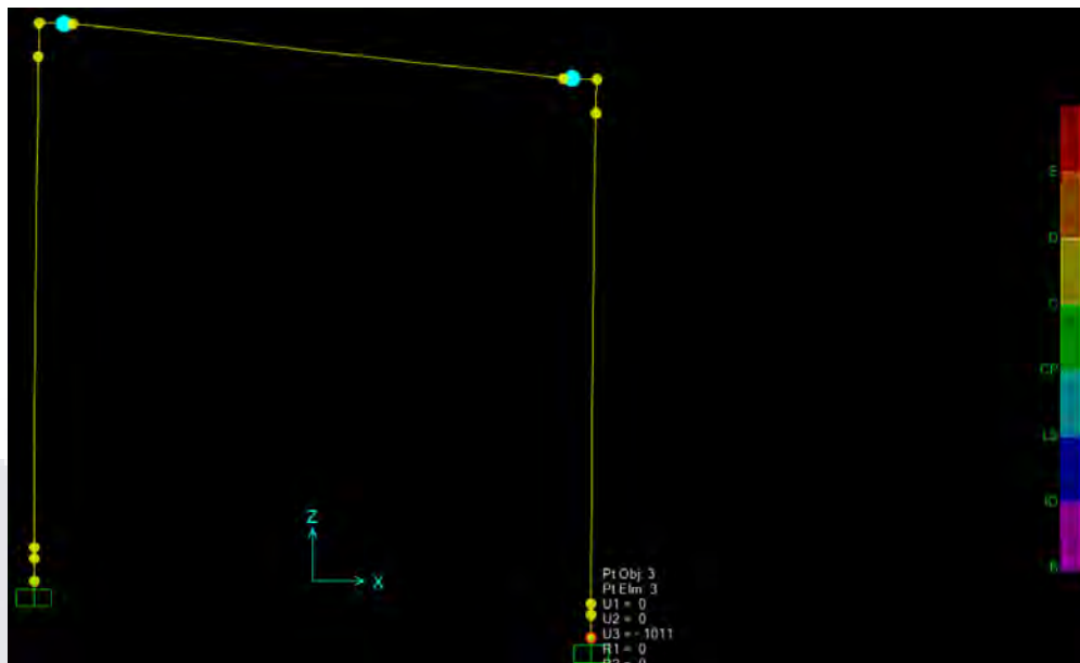
Figura 51: Marco estructural de 4 metros de largo y 4 metros de alto afectado por un hundimiento diferencial de 10.11 cm provocando un estado límite de servicio de seguridad de vida (LS, Life Safety por sus siglas en inglés).
