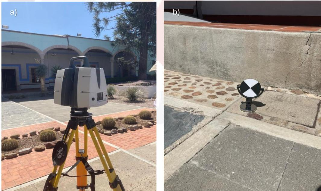
Figura 20. a) Estación de escaneo con la que se realizó el estudio, b) dianas de apoyo para la ejecución de este mismo.
