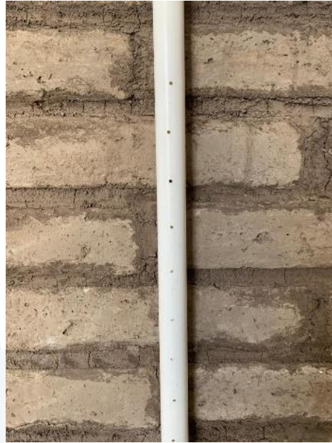
Figura 51: Tubería de PVC de 1", perforado para la simulación de humedad accidental donde se colocará al centro del muro. Imagen del autor.
