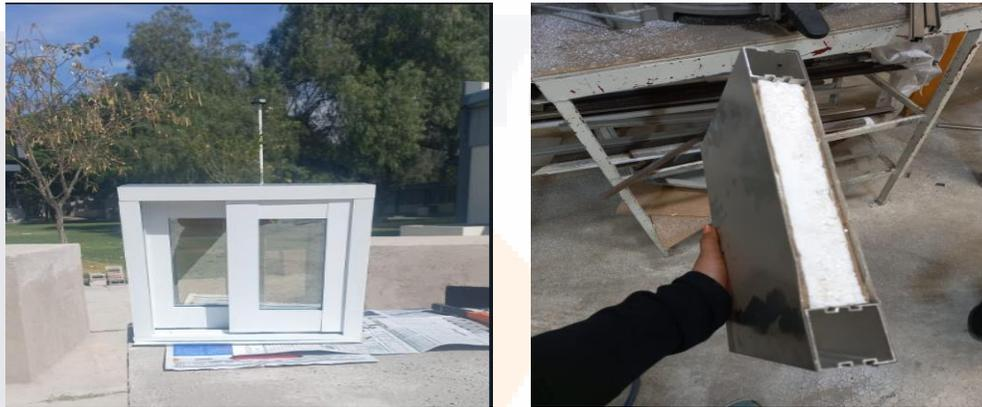
Figura 10. Ventana de aluminio con poliestireno, y vidrio sol-lite. Elaboración propia
