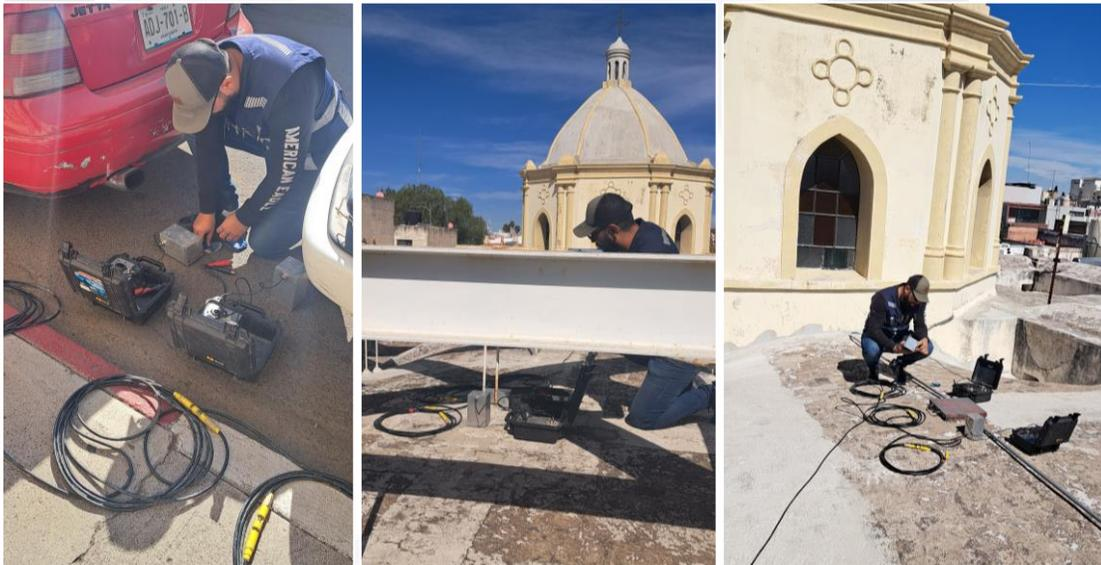
*Figura 25 Fotografía de registro de vibraciones en P-01, P-02 Y P-04, respectivamente*
