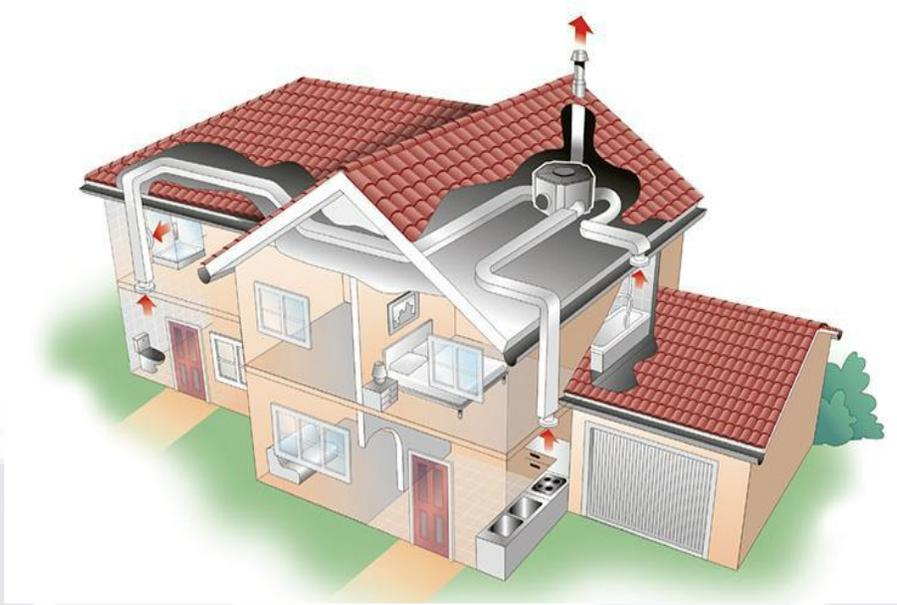
*Figura No. 10 Circulación del aire en el interior de la vivienda por el SVM.*
