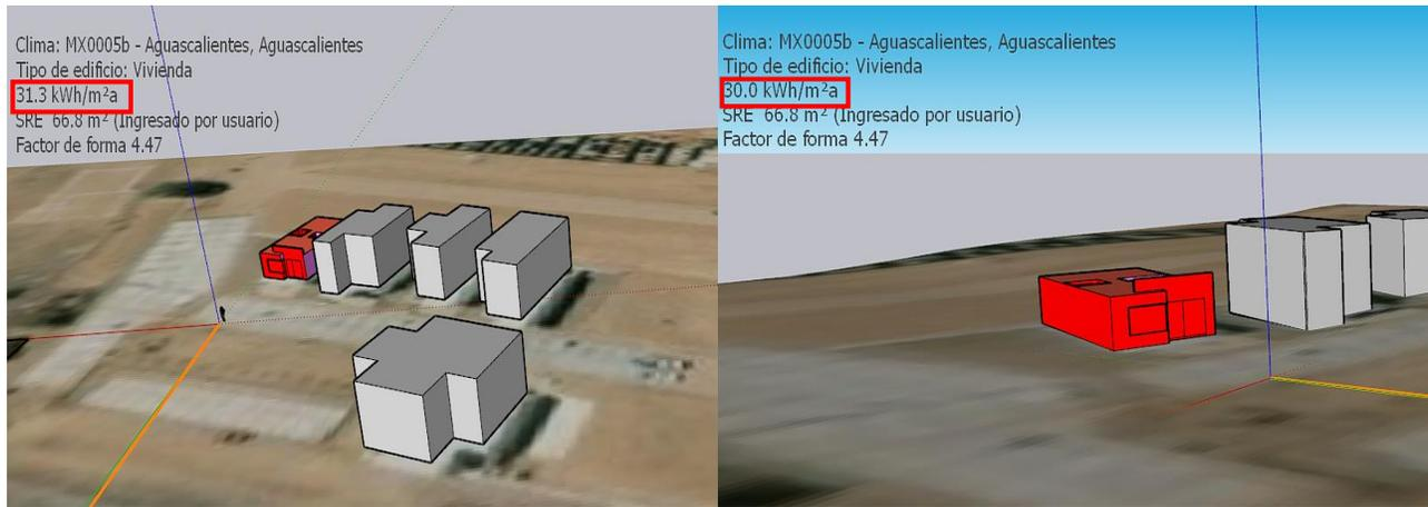
Figura No. 36 Modelo de la vivienda analizada en Bosque Sereno en su estado normal y con el sistema de VMC
