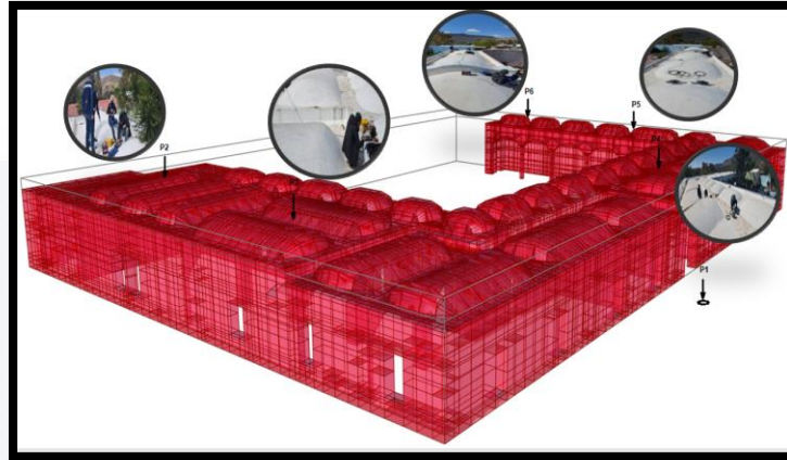
Figura 23. Puntos de medición de vibración ambiental.
