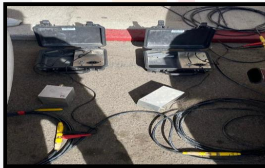
Figura 22. Imagen de sensores de velocidad empleados en la toma de lecturas. Fuente: elaboración propia
