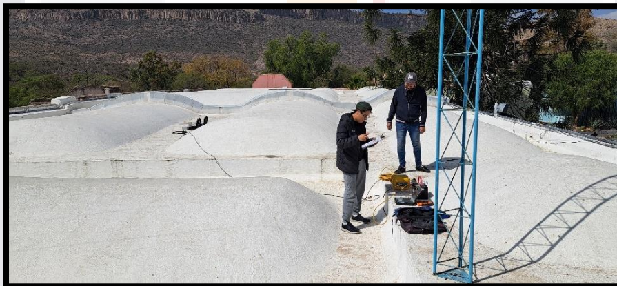
Figura 30. Mediciones de vibración ambiental sobre el punto 3.
