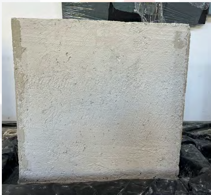
Ilustración 31 Muro recubierto de mortero 1:1:6 (cemento, cal, arena), (Muro 2 y 4). Imagen del autor.
