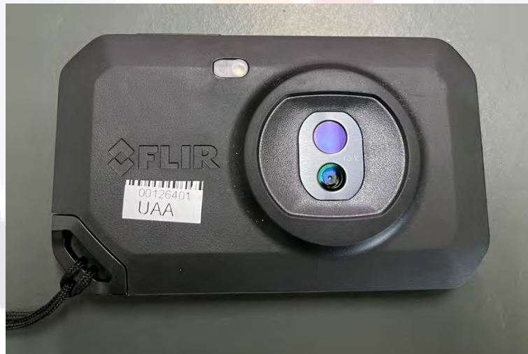
Ilustración 19 FLIR C 5 Cámara térmica compacta que mediante tecnología infrarroja detecta un diferencial de temperatura visible con tonos respectivos a las superficies en la pantalla. Imagen del autor.
