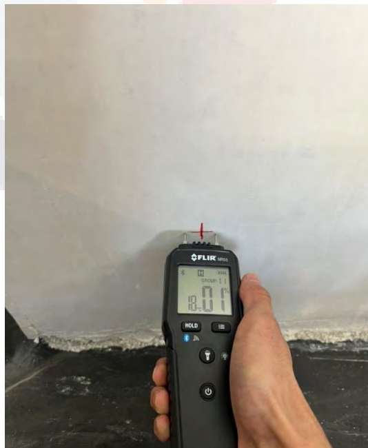
Ilustración 40 Toma de lectura en muro con el FLIR MR55, donde nos indica el grupo de materiales, la temperatura ambiente y el porcentaje de humedad en la zona. Imagen del autor.
