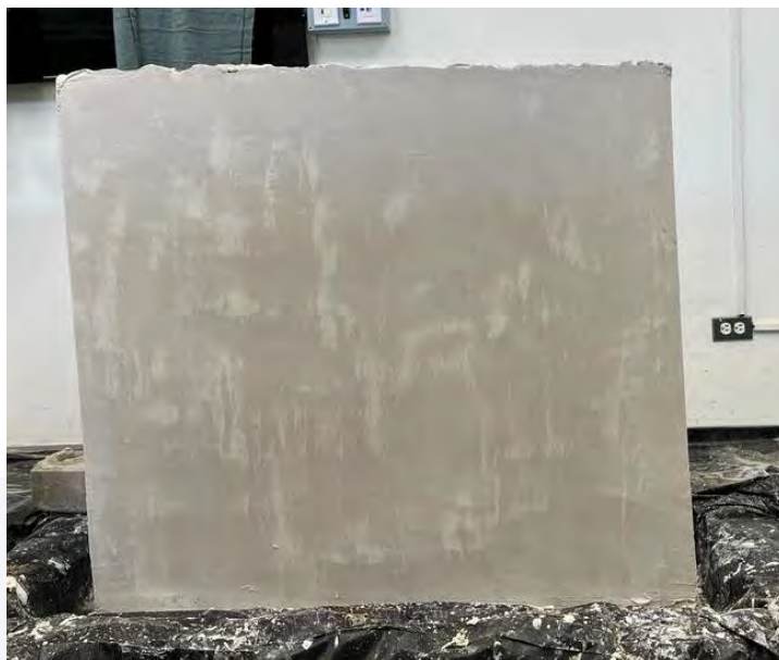
Ilustración 30 Muro recubierto de Yeso (Muro 1 y 3). Imagen del autor.
