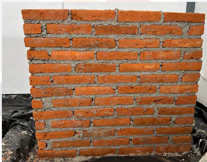
Ilustración 29 Muro de sustrato de ladrillo rojo recocido 7*14*28 cm (Muro 3 y 4). Imagen del autor.
