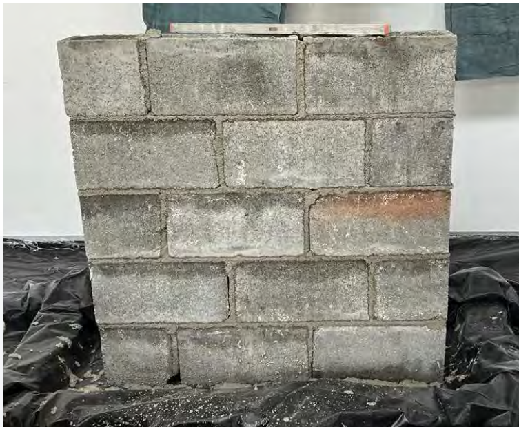
Ilustración 28 Muro de sustrato de block de concreto hueco 15*20*40 cm (Muro 1 y 2). Imagen del autor.
