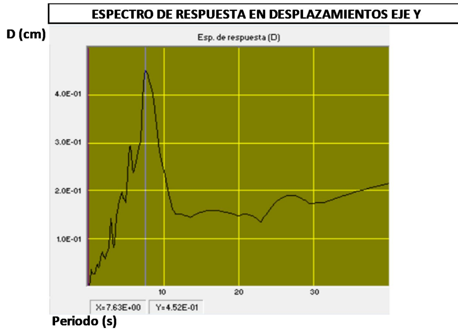
Ilustración 70 Espectro de respuesta para desplazamiento en Eje Y medida P1C4D
