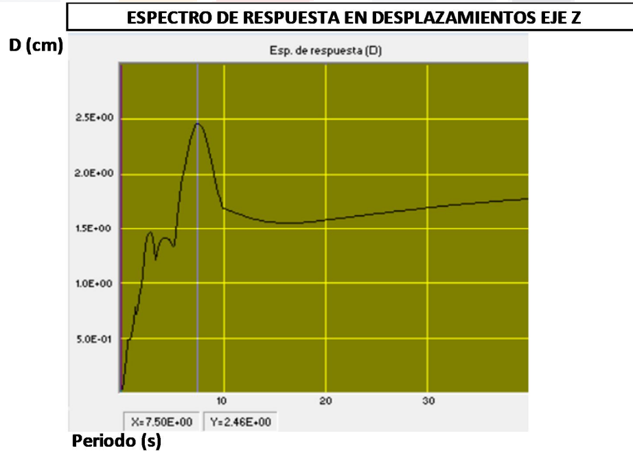
Ilustración 71 Espectro de respuesta para desplazamiento en Eje Z medida P1C4D
