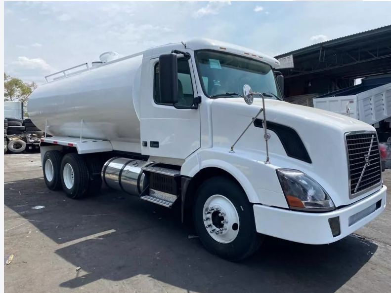
Ilustración 26 Vehículo para prueba controlada, pipa de 20,000 lts según normativa de peso y dimensiones de la NOM-012-SCT-2-2017
