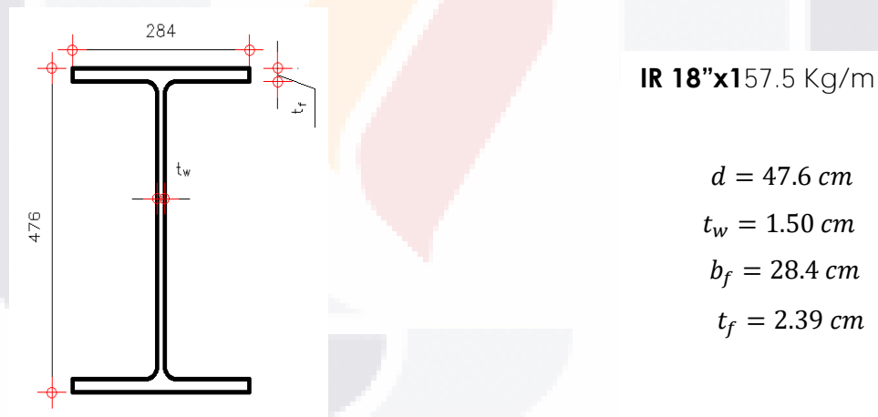
Figura 4 - 7. Viga VP-1, IR 18"x157.5 Kg/m.
