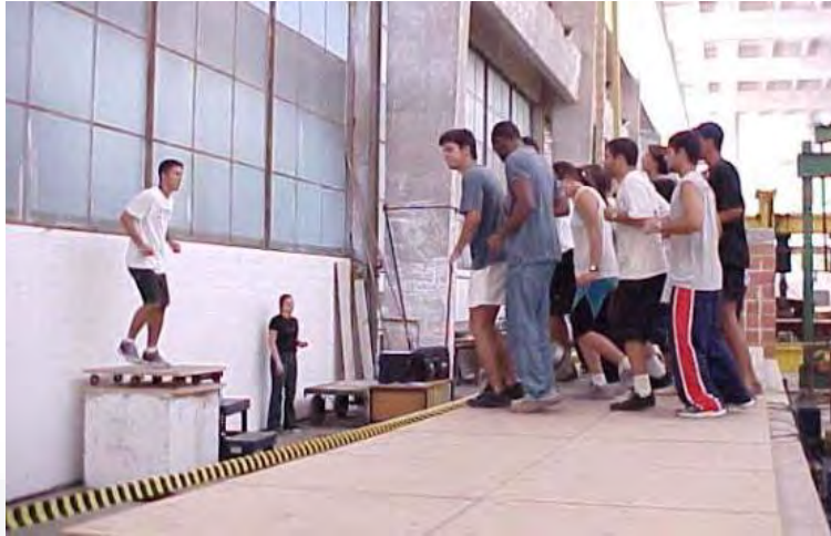
Figura 4 - 4. Instrumentación sobre plataforma experimental para actividades de gimnasia aeróbica (Faisca, 2003).
