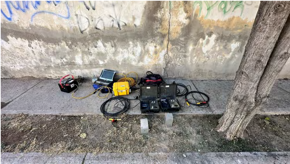
Figura 4. 36 Medición del sexto punto, vibración del suelo (fuente propia).
