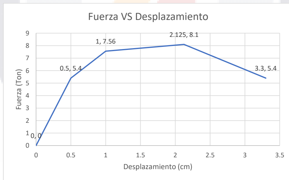
Figura 4. 23 Curva Fuerza-Desplazamiento de la mampostería (Fuente propia).
