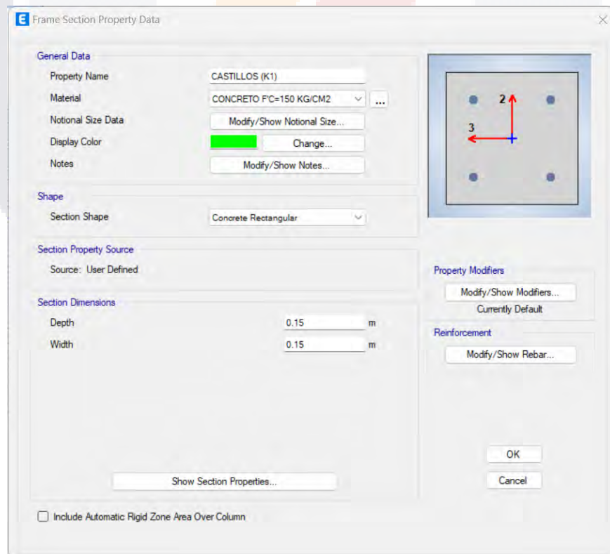
Figura 4. 5 Creación de sección para castillos en ETABS (fuente propia).
