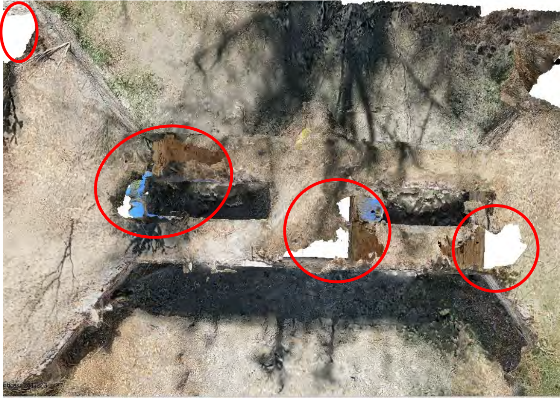
Figura 102. Detalle de huecos en modelo 3D, puente Peñuelas. Elaboración propia.
