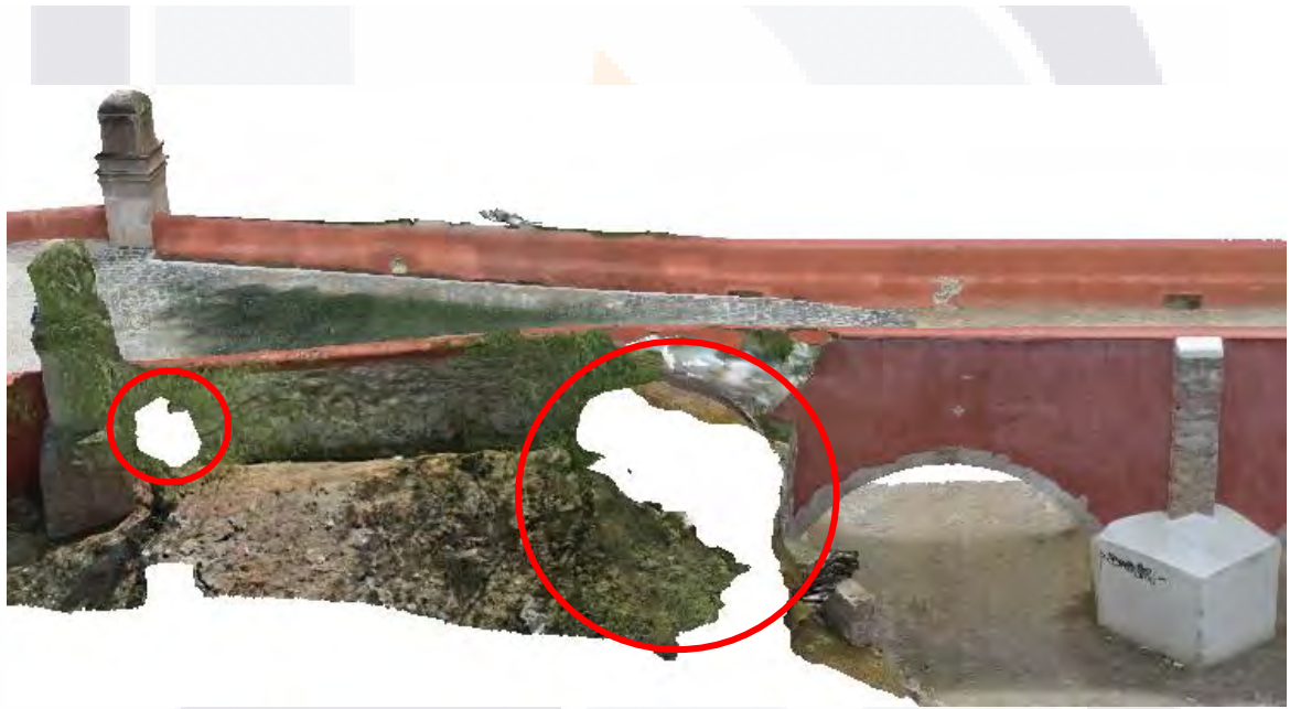
Figura 91. Detalle de huecos en modelo 3D, puente San Ignacio. Elaboración propia.
