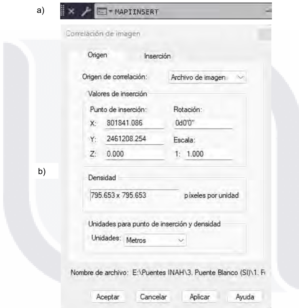
Figura 56. a) Comando mapiinsert de CIVIL 3D , b) Valores de inserción de ortofoto. Elaboración propia.
