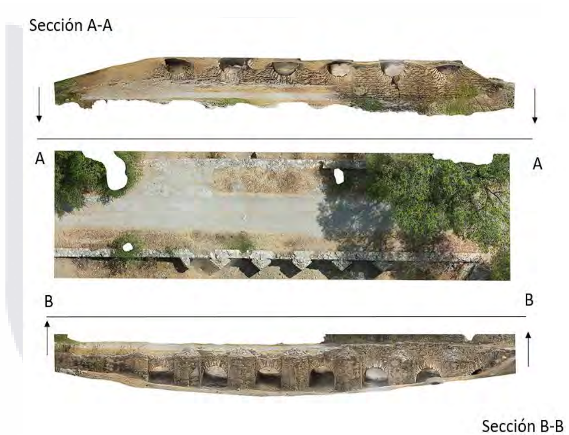
Figura 76. Ortofotos de planta y fachadas, puente El Tule. Elaboración propia.
