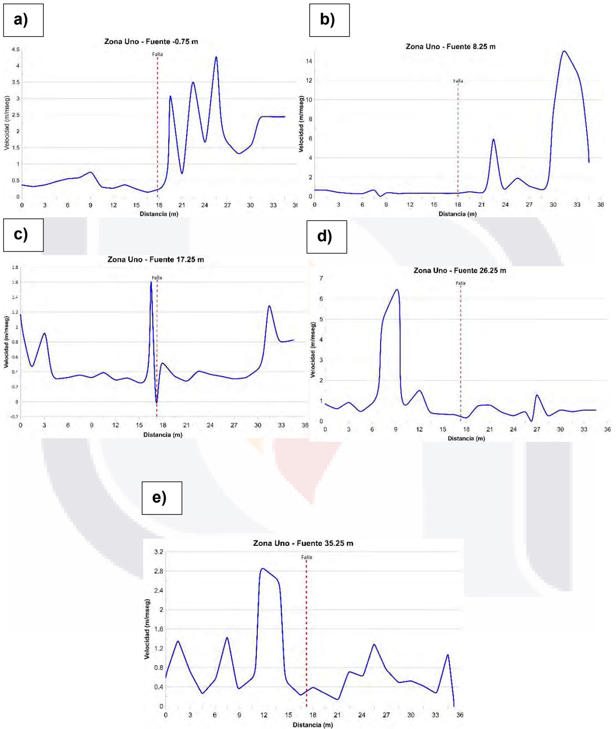
Gráficos de velocidades sondeo uno @1.5m por fuentes sísmicas realizadas. a) Fuente sísmica -0.75m b) Fuente sísmica 8.25m c) Fuente sísmica 17.25m d) Fuente sísmica 26.25m e) Fuente sísmica 35.25m
