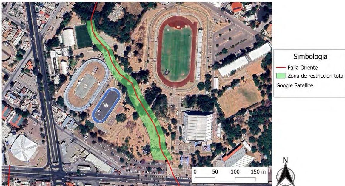
Figura 6.1. Ancho de influencia variable de la falla oriente en el área del Instituto del Deporte del Estado de Aguascalientes considerando únicamente los sondeos Geofísicos
