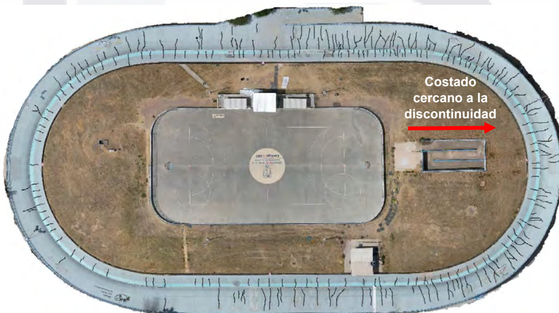
Figura 5.26 Mapeo de fisuras y grietas en la pista del velódromo utilizando la técnica de fotogrametría
