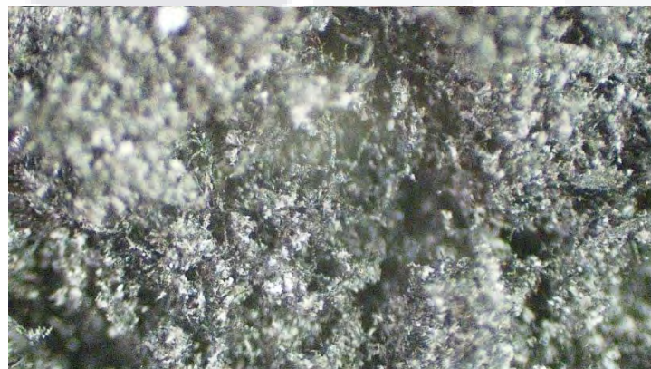
Fig 63. Fibras en muestra de ceniza rica lignina vistas a través de microscopio con aumento de 40x. Fuente: Propia.
