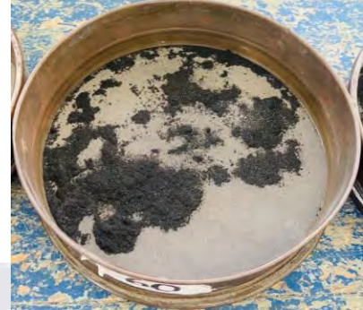
Fig 15. Material resultante de malla no. 40. (Izquierda). Fuente: Propia.
