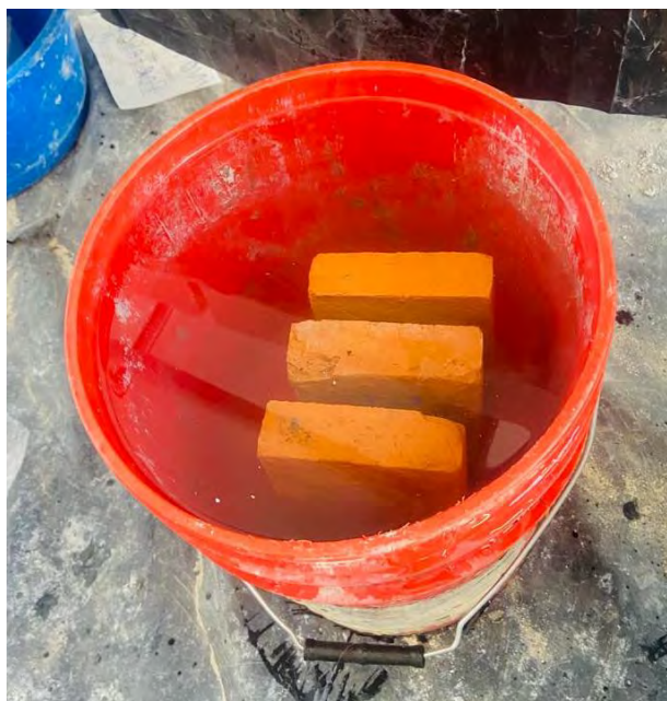
Fig. 49 y 50. Probetas sumergidas dentro de contenedor de agua y Pesaje de probetas saturada. Fuente: Propia.
