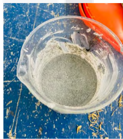
Fig. 35. Mezcla tradicional de cal adicionada con 20 g/lit. De cenizas con alto contenido de lignina. Fuente: Propia.
