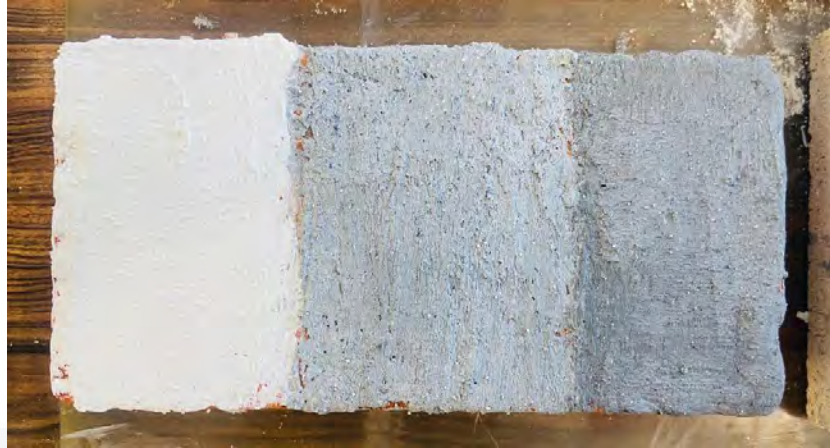
Fig. 38. Aplicación de muestras con diferentes proporciones de cenizas con alto contenido de lignina de la mezcla de cal de alta pureza en forma de pasta "Teocali" sobre sustrato de cuña de barro rojo recocido. Fuente: Propia.
