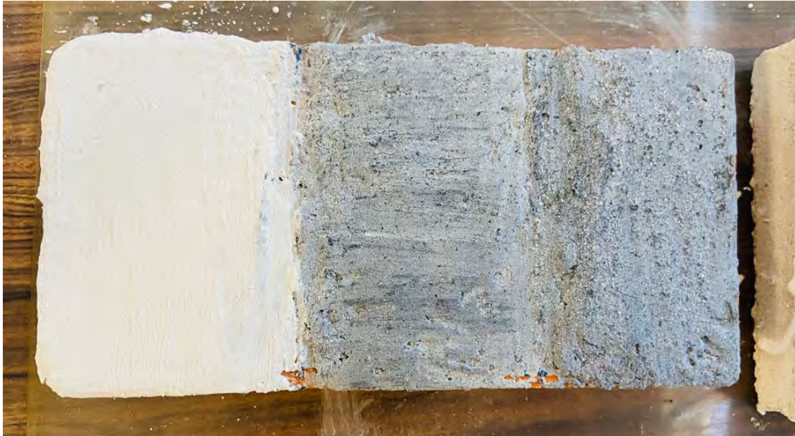
Fig. 36. Aplicación de muestras con diferentes proporciones de cenizas con alto contenido de lignina de la mezcla tradicional de cal sobre sustrato de cuña de tabique de barro rojo recocido. Fuente: Propia.
