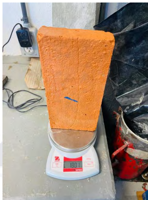
Fig. 49 y 50. Probetas sumergidas dentro de contenedor de agua y Pesaje de probetas saturada. Fuente: Propia.
