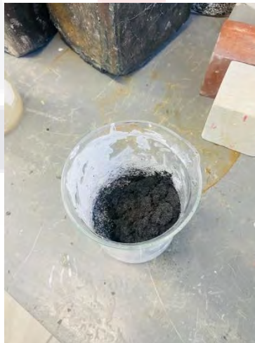
Fig. 31. Incorporación de cenizas con alto contenido en lignina a mezcla de cal de alta pureza en forma de pasta “Teocali”. Fuente: Propia.
