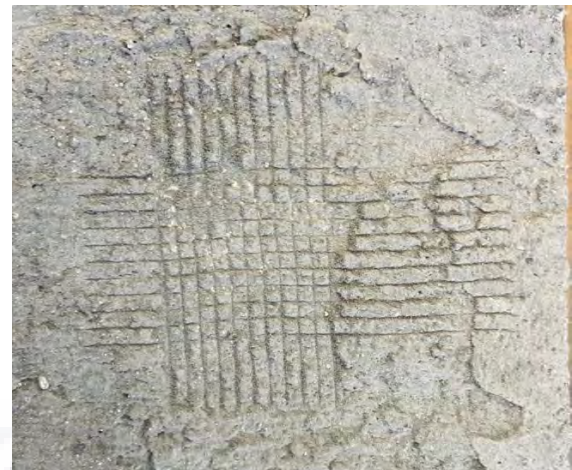
Fig. 45 y 46. Aplicación de método de revisión de desgaste de las superficies. (Norma ASTM). Fuente: Propia.
