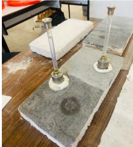
Fig. 57. Prueba de permeabilidad de segunda prueba piloto a través de tubos de Karsten. Fuente: Propia.
