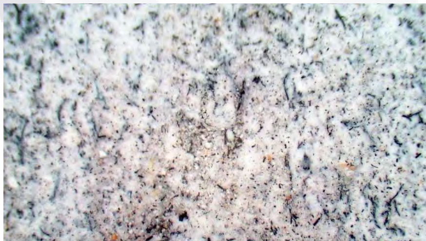
Figura 67. Imagen microscópica 2 de cal de alta pureza en forma de pasta "Teocali" adicionada con 20 g/lit de ceniza sobre superficie de mortero cal-arena 1:2 (aumento de 40x). Fuente: Propia.
