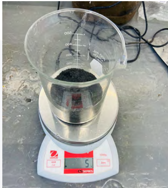
Figura 29. Pesaje de cenizas con alto contenido de lignina para incorporación en mezclas de cal. Fuente: Propia.
