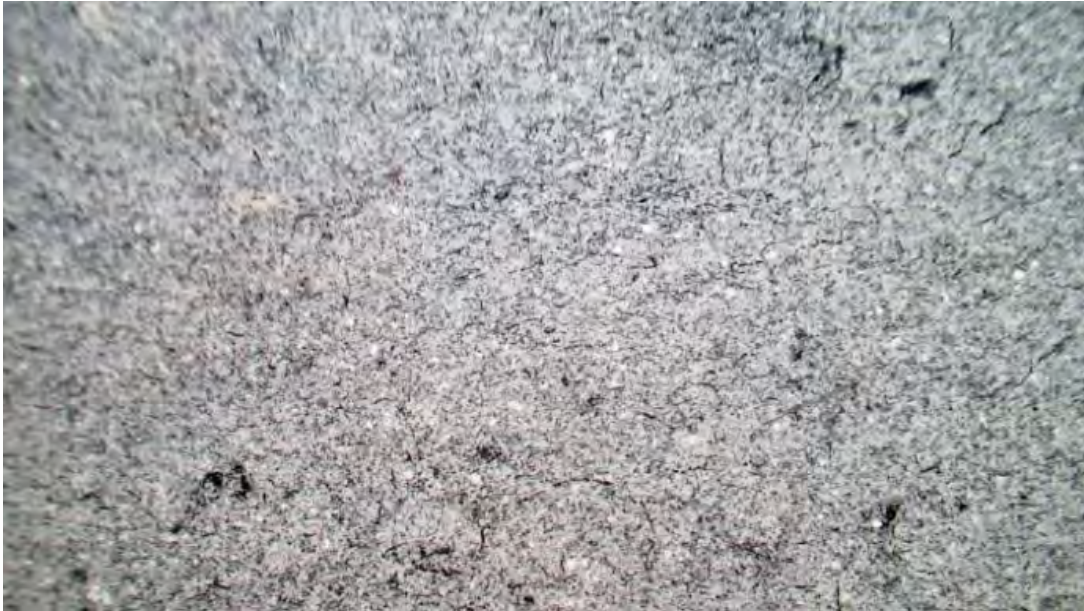
Figura 72. Imagen microscópica 1 de mezcla tradicional de cal adicionada con 35 g/lt de ceniza sobre superficie de mortero cal-arena 1:2 (aumento de 20x). Fuente: Propia.
