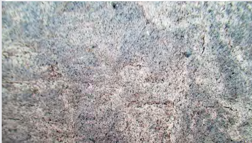
Figura 81. Imagen microscópica 2 de mezcla tradicional de cal adicionada con 50 g/lt de ceniza sobre superficie de mortero cal-arena 1:2 (aumento de 30x). Fuente: Propia.
