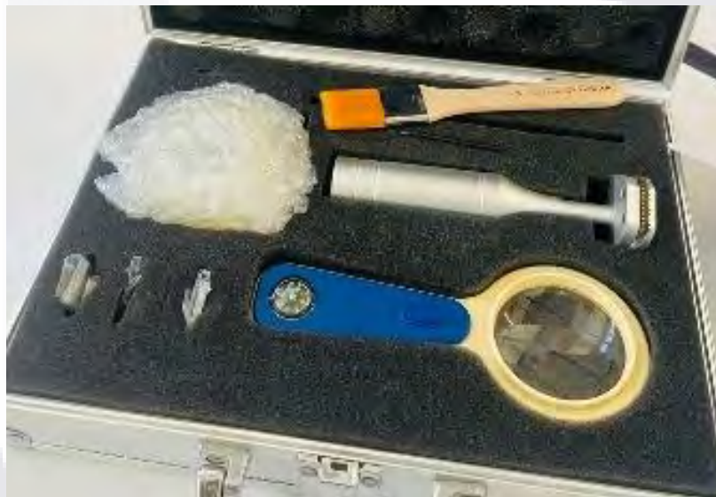
Fig. 44. Kit de adherencia para revisión de desgaste de las superficies. Fuente: Propia.
