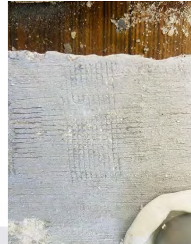
Fig. 59. Probeta de segunda prueba piloto después de aplicación del método de revisión de desgaste. Fuente: Propia.
