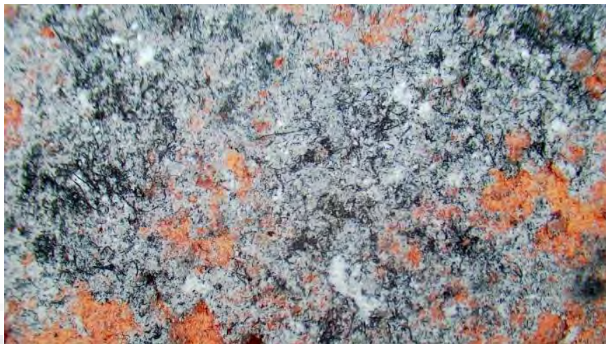
Figura 77. Imagen microscópica 2 de mezcla tradicional de cal adicionada con 35 g/lt de ceniza sobre superficie de cuña de barro rojo recocido (aumento de 30x). Fuente: Propia
