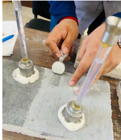
Fig. 58. Prueba de adherencia de segunda prueba piloto a través de método de revisión de desgaste. Fuente: Propia.
