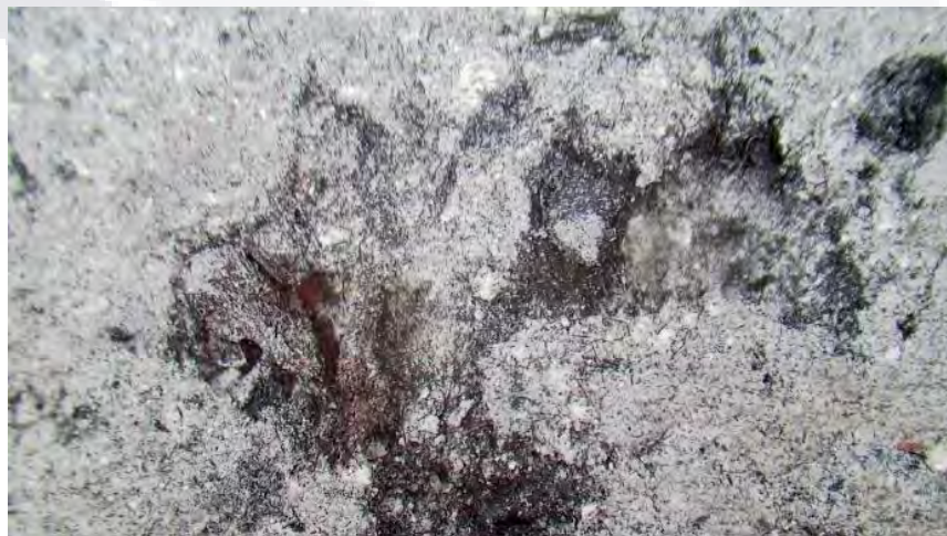
Figura 85. Imagen microscópica 2 de mezcla tradicional de cal adicionada con 50 g/lit de ceniza sobre superficie de cuña de barro rojo recocido (aumento de 40x). Fuente: Propia.
