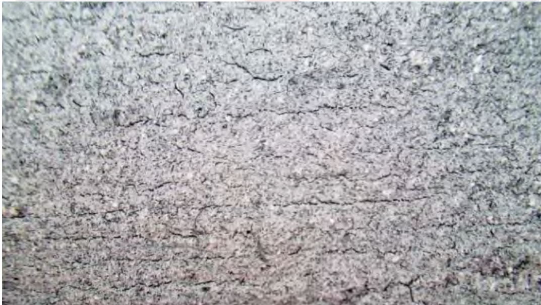
Figura 73. Imagen microscópica 2 de mezcla tradicional de cal adicionada con 35 g/lt de ceniza sobre superficie de mortero cal-arena 1:2 (aumento de 30x). Fuente: Propia.
