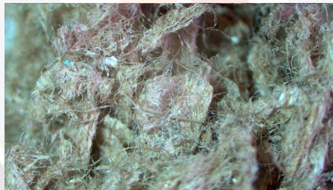
Fig 7. Imagen microscópica de material de fibra de cartón (aumento de 20x). Fuente: Propia.
