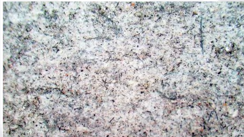
Figura 66. Imagen microscópica 1 de cal de alta pureza en forma de pasta "Teocali" adicionada con 20 g/lit de ceniza sobre superficie de mortero cal-arena 1:2 (aumento de 30x). Fuente: Propia.
