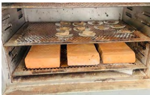
Fig. 48. Secado de probetas en horno a 100 °C. Fuente: Propia.
