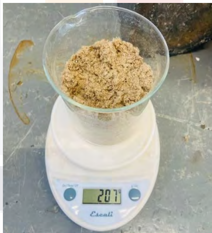
Fig 9. Peso del material con pérdida de humedad. Fuente: Propia.
