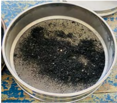
Fig 15. Material resultante de malla no. 40. (Izquierda). Fuente: Propia.
