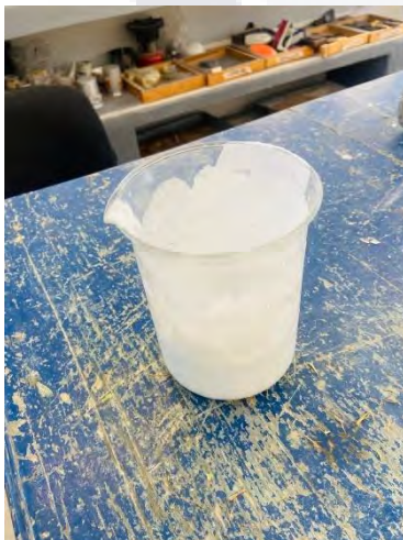
Fig. 30. Mezcla de cal de alta pureza en forma de pasta teocali. Fuente: Propia.
