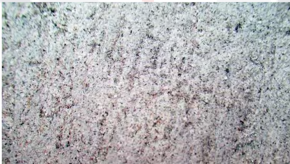
Figura 64. Imagen microscópica 1 de mezcla tradicional de cal adicionada con 20 g/lt de ceniza sobre superficie de mortero cal-arena 1:2 (aumento de 30x). Fuente: Propia.
