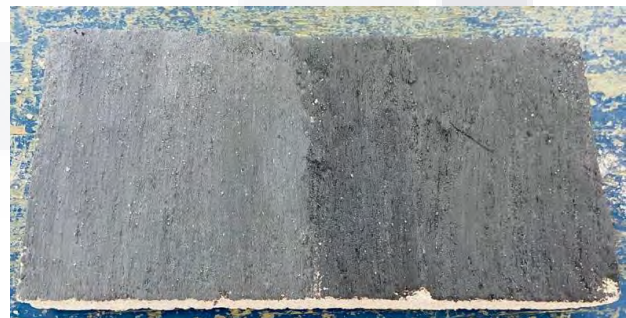
Fig. 56. Aplicación de cal de alta pureza en forma de pasta “Teocali” con proporciones de cenizas correspondientes a segunda prueba piloto sobre sustrato de mortero cal-arena 1:2. Fuente: Propia.
