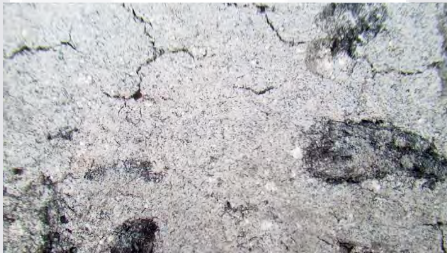
Figura 84. Imagen microscópica 1 de mezcla tradicional de cal adicionada con 50 g/lit de ceniza sobre superficie de cuña de barro rojo recocido (aumento de 30x). Fuente: Propia.
