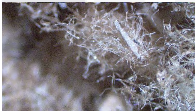
Fig 8. Imagen microscópica de material de fibra de cartón (aumento de 40x). Fuente: Propia.
