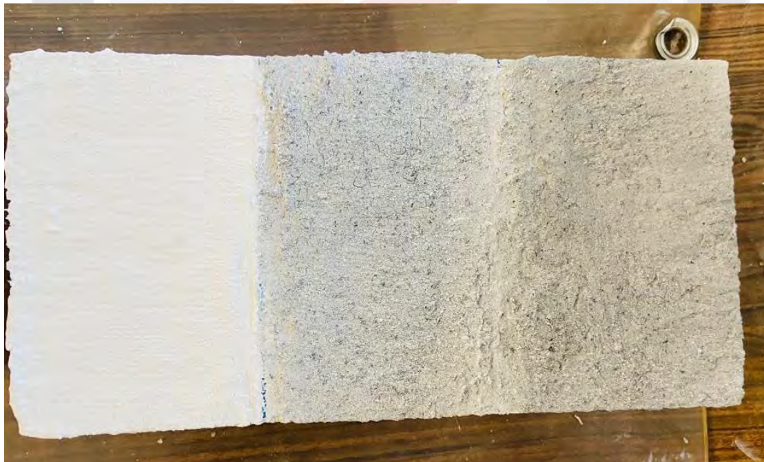
Fig. 37. Aplicación de muestras con diferentes proporciones de cenizas con alto contenido de lignina de la mezcla tradicional de cal sobre sustrato de mortero cal-arena 1:2. Fuente: Propia.
