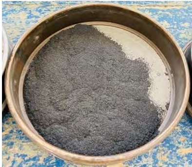
Fig 18. Material resultante de malla no. 100. (Izquierda). Fuente: Propia.
