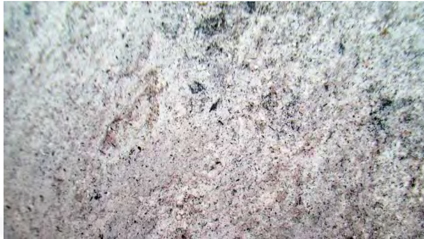
Figura 65. Imagen microscópica 2 de mezcla tradicional de cal adicionada con 20 g/lit de ceniza sobre superficie de mortero cal-arena 1:2 (aumento de 40x). Fuente: Propia.
