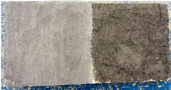
Fig. 55. Aplicación de mezcla tradicional de cal con proporciones de cenizas correspondientes a segunda prueba piloto sobre sustrato de mortero cal-arena 1:2. Fuente: Propia.
