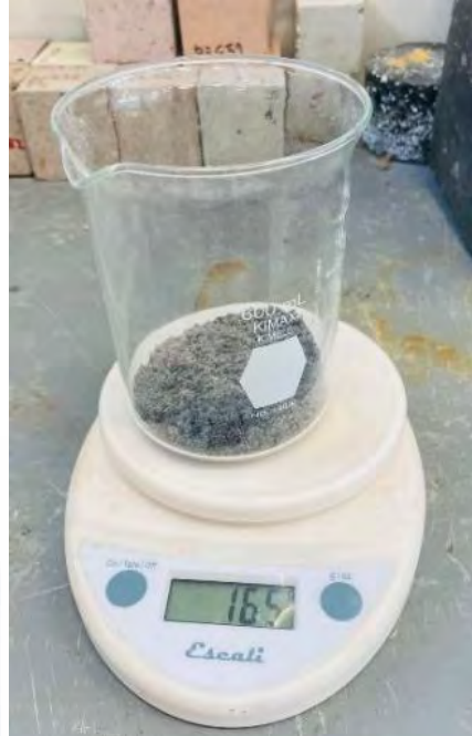
Fig. 12. Pesaje de las cenizas obtenidas en contenedor. (160 g + 5 g) Fuente: Propia.
