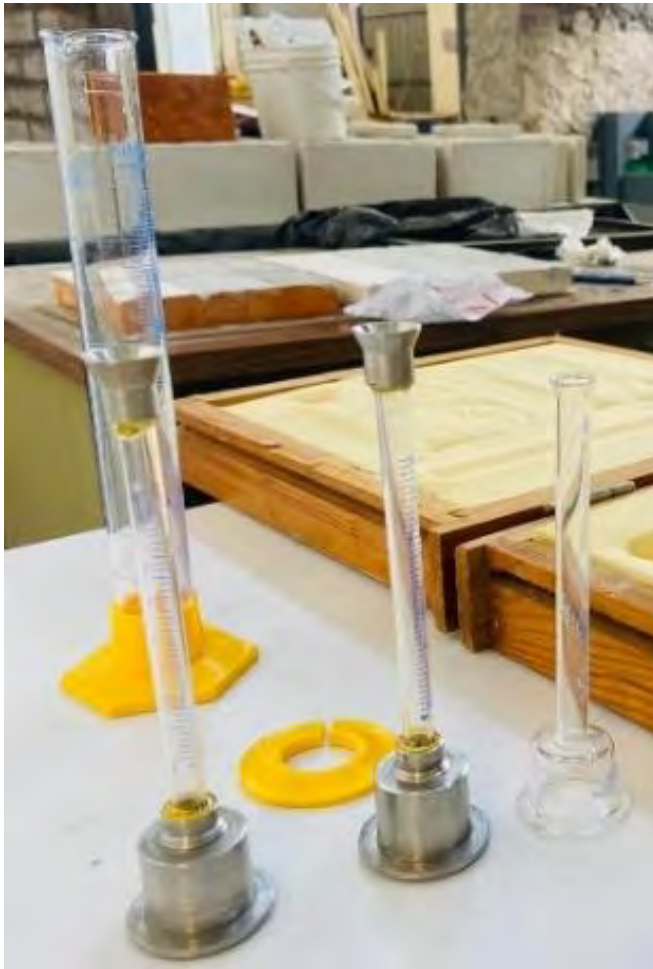
Fig. 42. Tubos de Karsten. Fuente: Propia.
