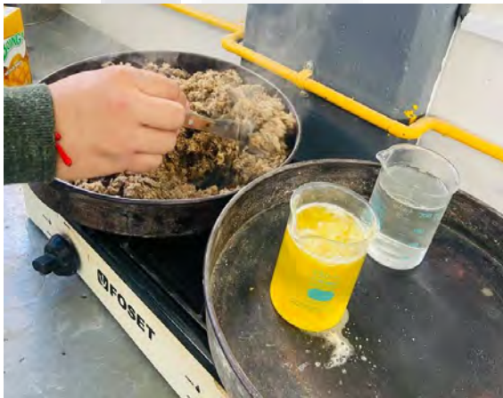
Fig. 53. Incineración de material de fibras de cartón y elaboración de mezcla tradicional de cal Fuente: Propia.
