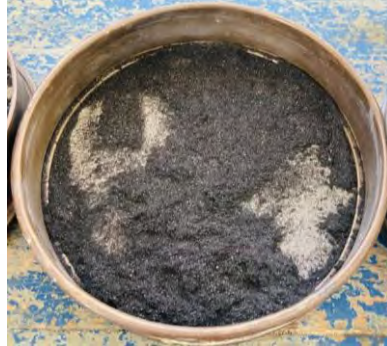
Fig 15. Material resultante de malla no. 40. (Izquierda). Fuente: Propia.
