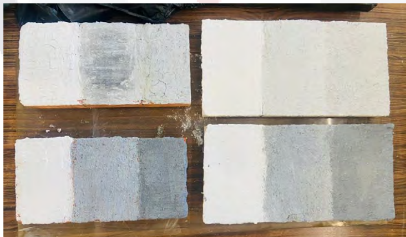
Fig. 40. Probetas de prueba piloto cubiertas por mezclas de cal. (mezcla tradicional de cal-parte superior; mezcla de cal de alta pureza en forma de pasta "Teocali"- parte inferior) (sustratos de cuña de barro rojo recocido- parte izquierda; sustratos de mortero cal-arena 1:2- parte derecha). Fuente: Propia.
