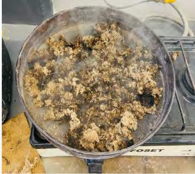
Fig. 10. Calcinación de material en superficie metálica sobre estufa. Fuente: Propia.
