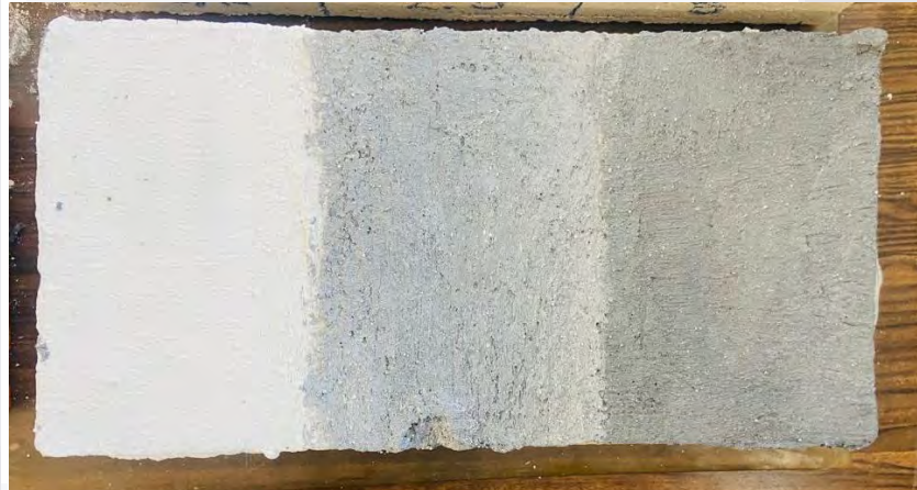
Fig. 39. Aplicación de muestras con diferentes proporciones de cenizas con alto contenido de lignina de la mezcla de cal de alta pureza en forma de pasta "Teocali" sobre sustrato de mortero cal-arena 1:2. Fuente: Propia.
