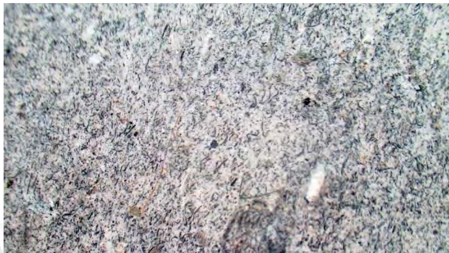
Figura 74. Imagen microscópica 1 de cal de alta pureza en forma de pasta "Teocali" adicionada con 35 g/lit de ceniza sobre superficie de mortero cal-arena 1:2 (aumento de 20x). Fuente: Propia.
