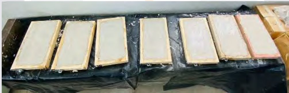
Fig. 23. Construcción de probetas de mortero cal-arena 1:2 a mayor escala. Fuente: Propia.
