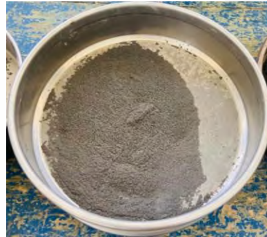
Fig 18. Material resultante de malla no. 100. (Izquierda). Fuente: Propia.
