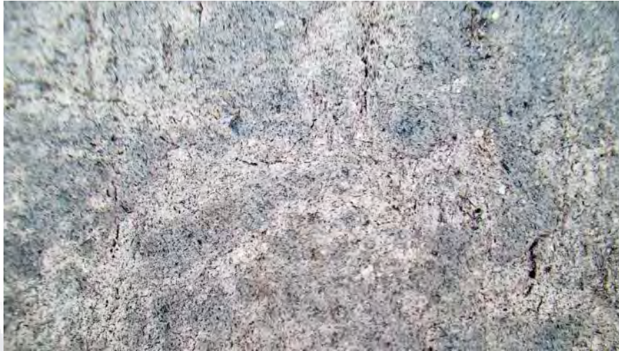
Figura 80. Imagen microscópica 1 de mezcla tradicional de cal adicionada con 50 g/lt de ceniza sobre superficie de mortero cal-arena 1:2 (aumento de 20x). Fuente: Propia.
