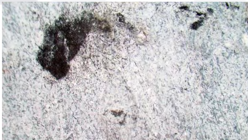
Figura 82. Imagen microscópica 1 de cal de alta pureza en forma de pasta "Teocali" adicionada con 50 g/lt de ceniza sobre superficie de mortero cal-arena 1:2 (aumento de 40x). Fuente: Propia.
