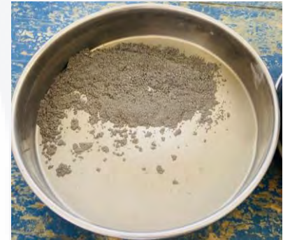
Fig 18. Material resultante de malla no. 100. (Izquierda). Fuente: Propia.
