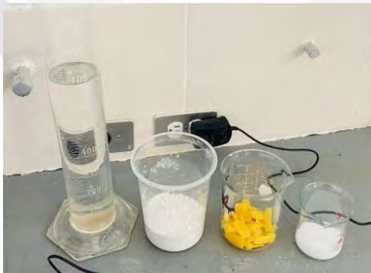
Fig. 25. Componentes de mezcla tradicional de cal. Fuente: Propia.
