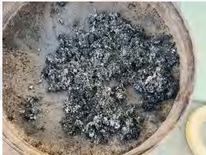
Fig. 11. Cenizas obtenidas de la calcinación de material de fibras de cartón con alto contenido de lignina. Fuente: Propia.
