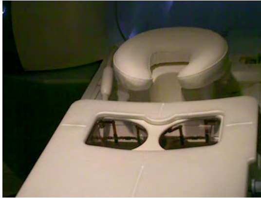
FIGURA. 2-10 Antena T/R de la RM de 1.5 T marca SIEMENS ubicada en el Centenario Hospital Miguel Hidalgo del estado de Aguascalientes
