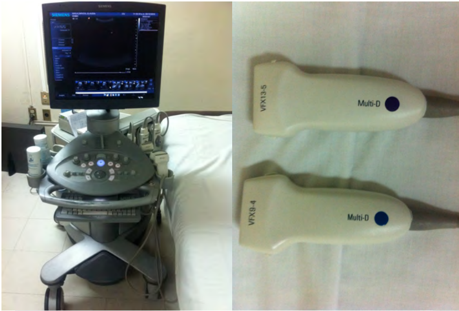
Fig 7.3 Equipo de ultrasonido Antares, así como transductores lineales multifrecuencia para exploración de la mama del CHMH
