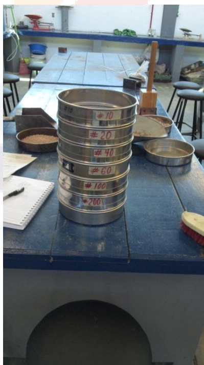
Figura 3.5 Orden de los tamices para cribado de suelo
