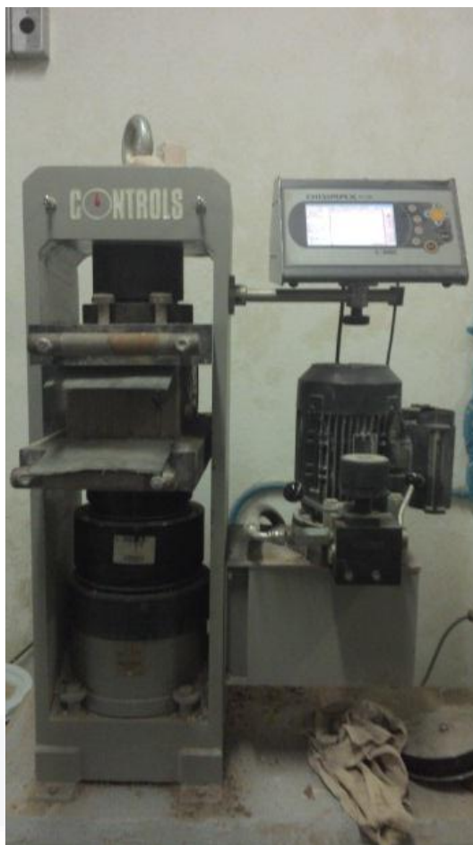
Figura 3.21 Prensa para el ensayo de los bloques
