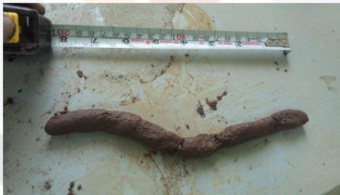
Figura 3.12 Pruebas de plasticidad suelo 1
