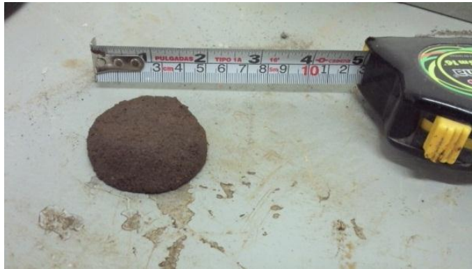
Figura 3. 11 Prueba de cohesión del suelo 4
