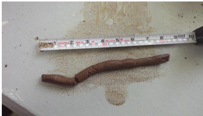
Figura 3.13 Pruebas de plasticidad del suelo 2
