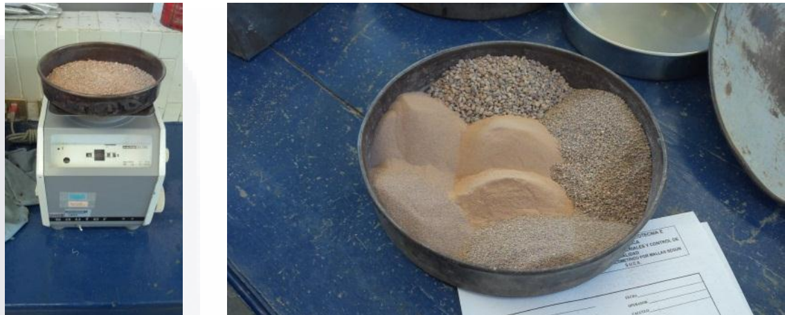
Figura 3.6 Pesado de material retenido en cada malla
