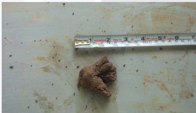
Figura 3.14 Pruebas de plasticidad suelo 3
