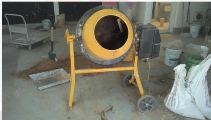
Figura 3.20 Revolvedora de medio saco
