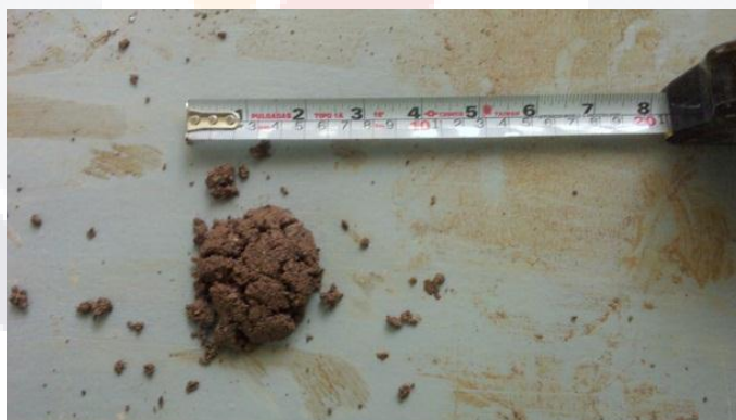
Figura 3.10 Prueba de cohesión del suelo 3
