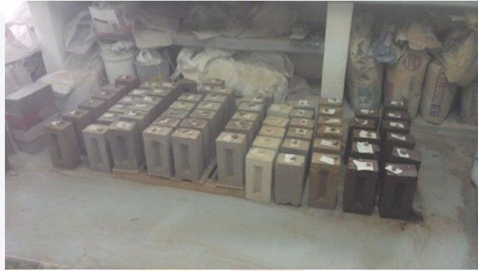
Figura 3.23 Bloques de diferentes tipos de suelo y edades de curado.
