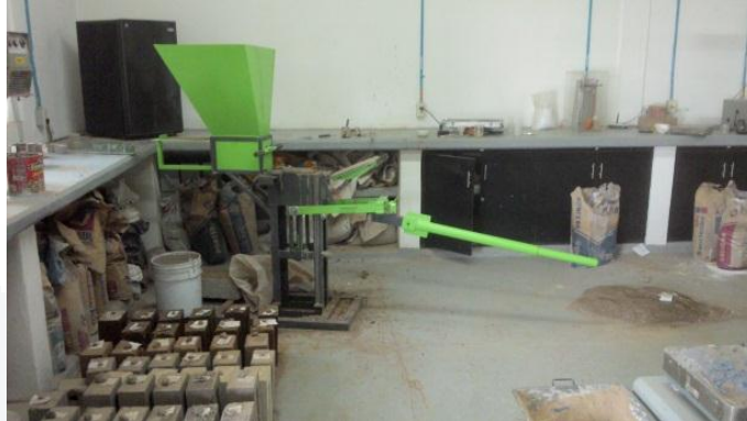
Figura 3.19 Prensa manual Tecnoadobe
