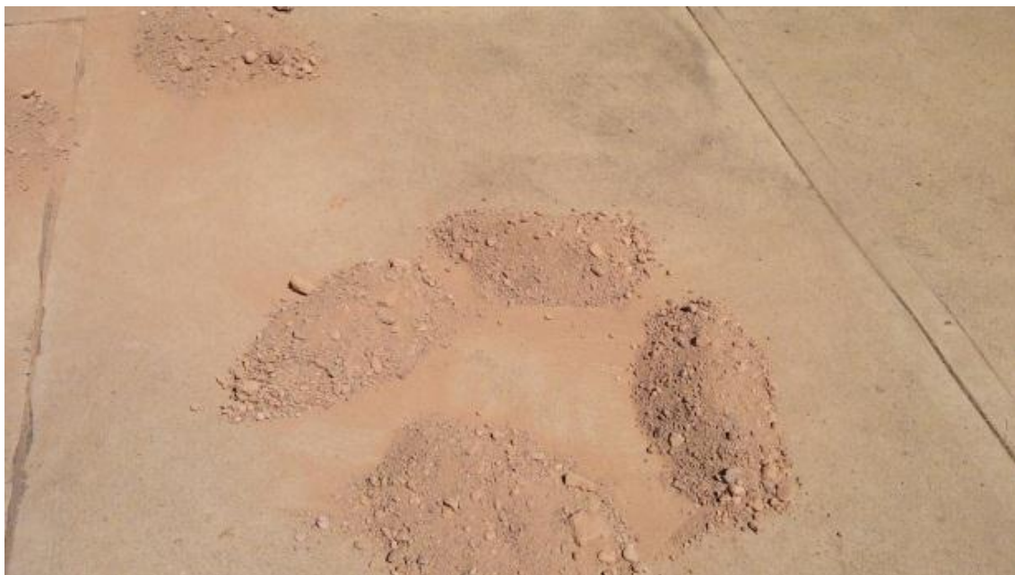
Figura 3.4 Disgregado y cuarteo de la muestra
