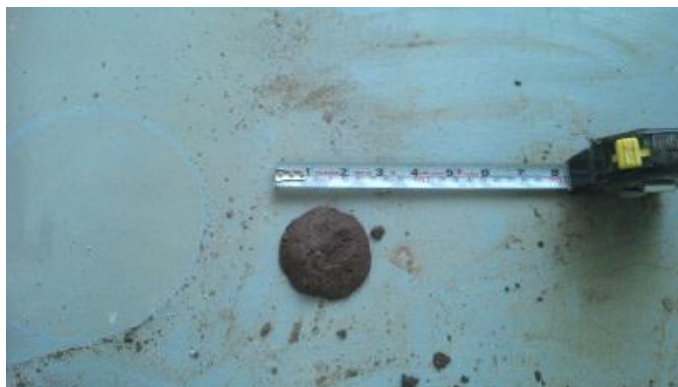
Figura 3.8 Prueba de cohesión del suelo 1
