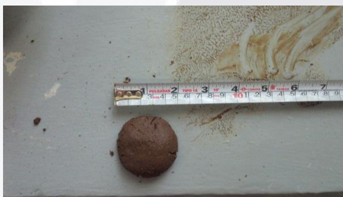
Figura 3.9 Prueba de cohesión del suelo 2
