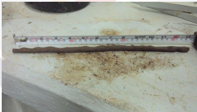
Figura 3.15 Pruebas de plasticidad suelo 4
