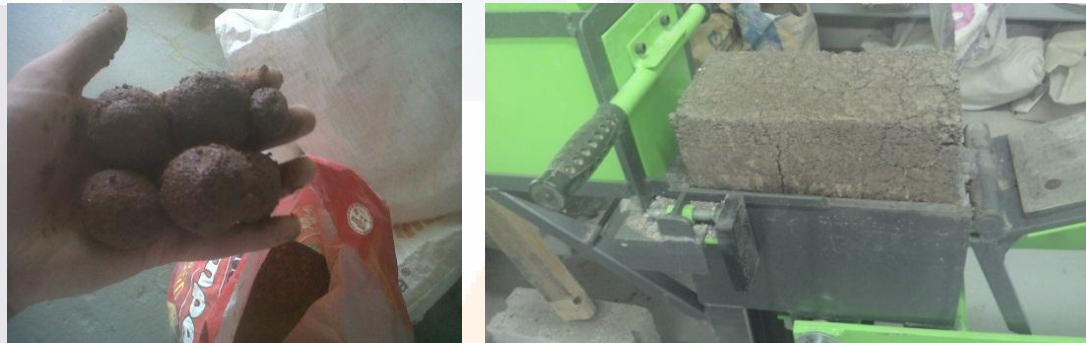
Figura 3.25 Deficiencias de mezclado debido a ausencia de cal en el suelo
