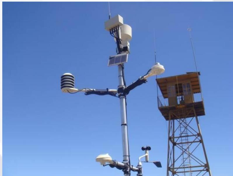
**Figura 6.** Sensores que conforman una estación agroclimatológica para medir variables climáticas de interés agrícola.
