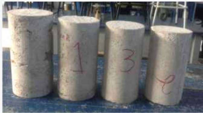
Figura 2.1.2 Desmolde y caracterización de especímenes de mortero
