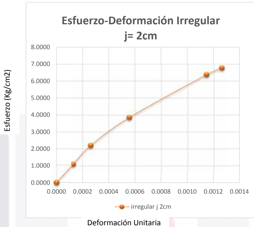
Gráfica 4.1.1 Esfuerzo-Deformación de mampostería irregular con relleno y juntas de 2 cm.
