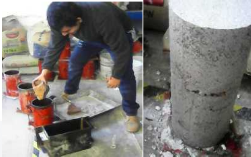
Figura 2.2.1 Hechura de especímenes de mortero con cantera
