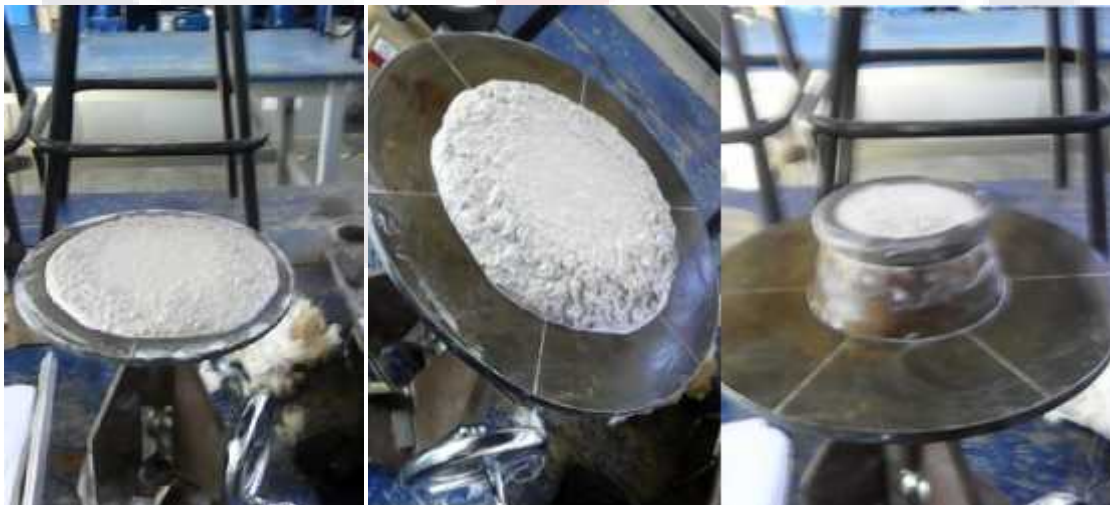
Figura 2.0.2 Prueba de aumento de diámetro
