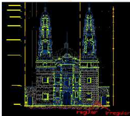
Figura 3.2.1 muestras de modelos de mampostería regular y mampostería irregular sacados de la catedral
