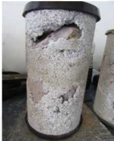
Figura 2.2.3 Detección de huecos
