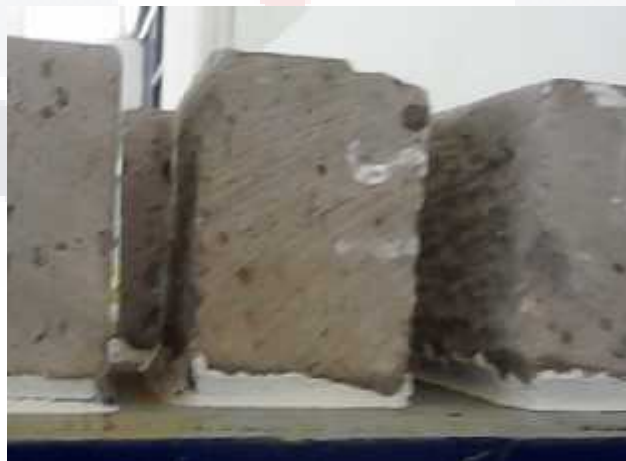
Figura 2.3.2 Cabeceado de bloques
