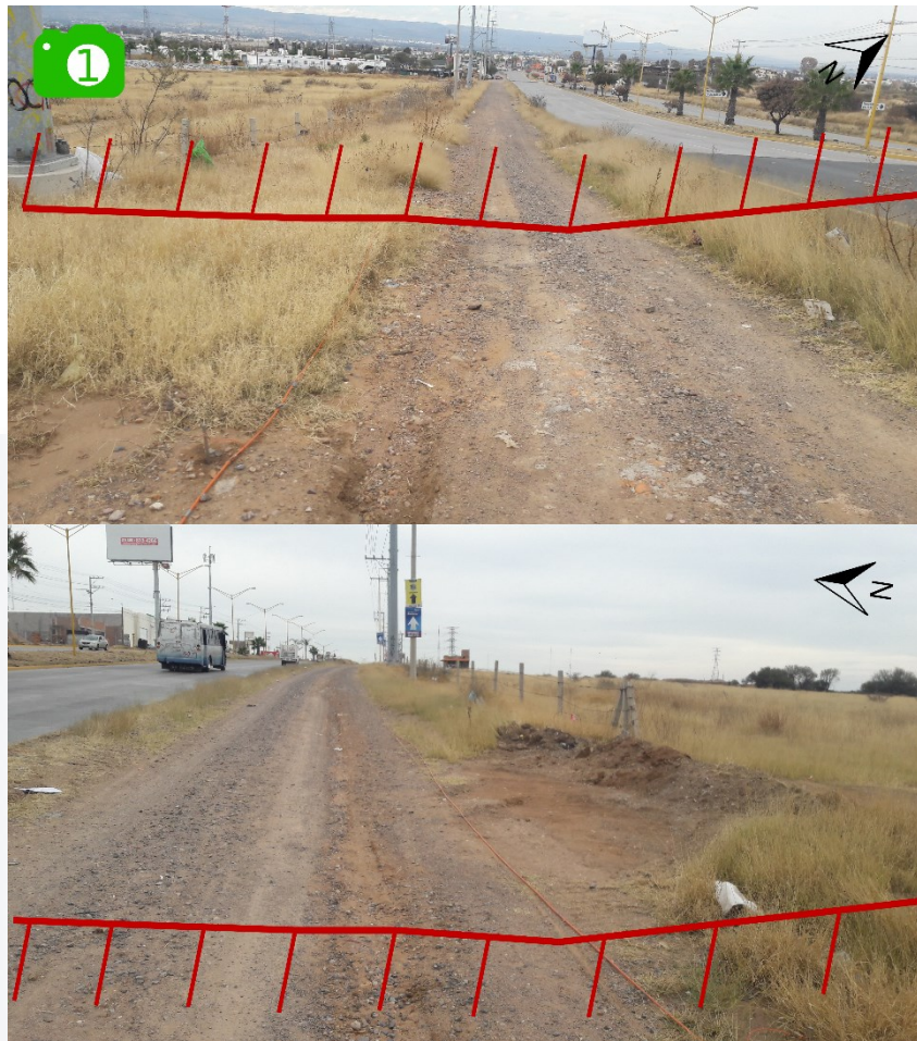
Figura 5.51 Imagen del sitio 11, la ubicación de las imágenes se muestra en la Figura 5.46 1) Muestra la falla, superior vista hacia el poniente e inferior vista al oriente.
