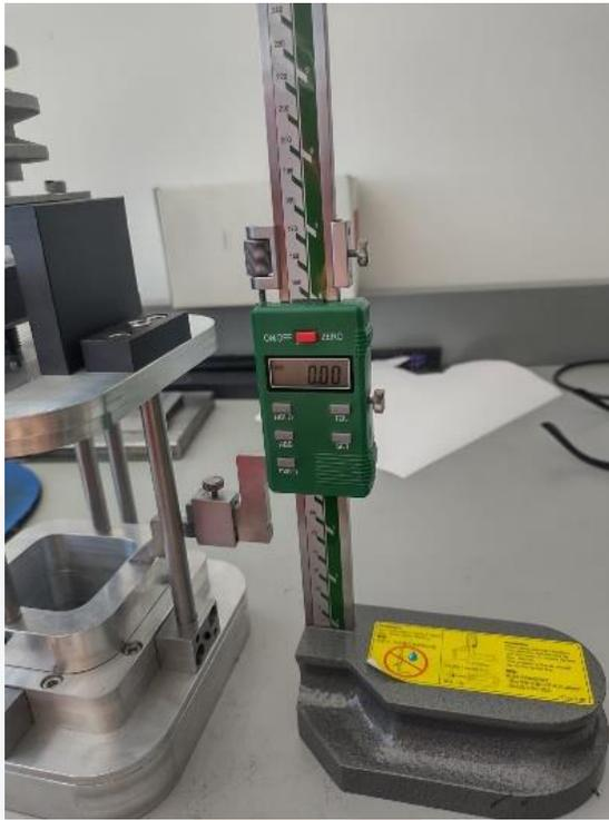
Figura 33. Medición con vernier de alturas digital
