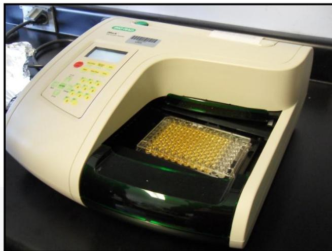
**Figura 2. Lector de ELISA iMARK™.** Lector de ELISA mide la absorbancia de los 96 pocillos a una longitud de onda de 490nm.
