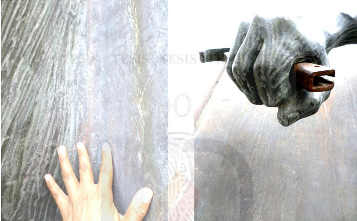
Imagen 30. Cacamatzin manchas rojas de corrosión de hierro en forma de escurrimientos. (Archivo fotográfico del Centro INAH Aguascalientes).
