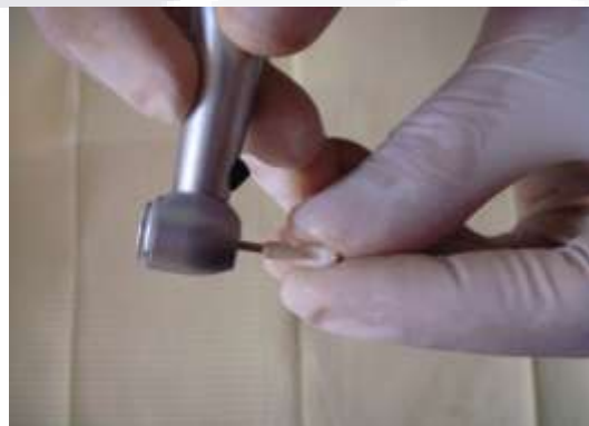
Fig. 11. Pulido de las muestras seccionadas.
