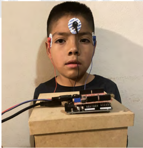
Figura 2.7: Colocación de electrodos para la captura de señales EOG.
