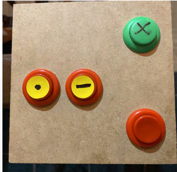
Figura 3.16: Sistema de botones incluido en el prototipo A.
