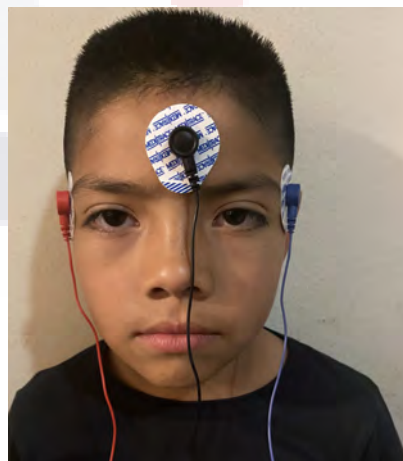
Figura 3.5: Colocación de electrodos en configuración horizontal para obtener señales EOG.
