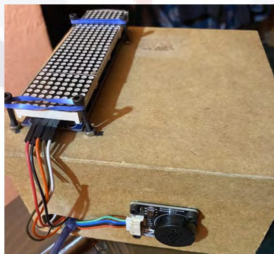
Figura 3.17: Pantalla incluida en el prototipo A.
