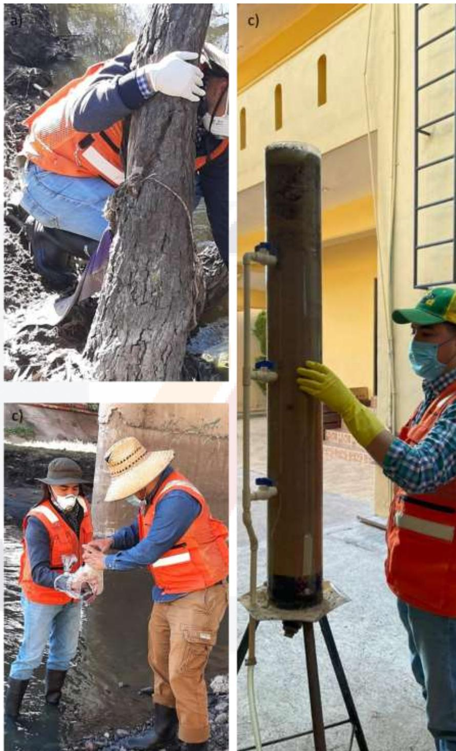
**Figura 11.** Ejecución de muestreos para pruebas de toxicidad en campo/dispositivo
