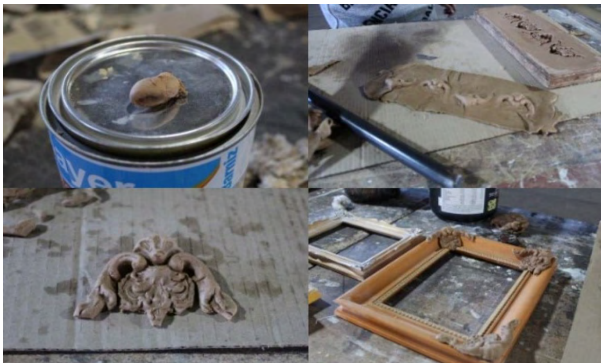
Imagen 45. Elaboración propia. Arriba (Izq.) Masilla que se utiliza para fabricar el campo. Arriba (Der.) Molde donde se coloca la masilla para fabricar el campo, se procedió a realizarlo. Sin embargo, no paso el control de calidad y se vuelven a realizar. Abajo (Izq.) Pieza del campo terminado y listo para colocar en el marco. Abajo (Der.) Marco con tres piezas de campo colocadas en las esquinas.
