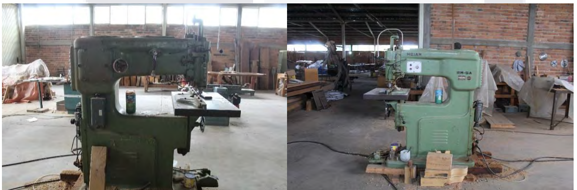
Imagen 75. Elaboración propia. Trompo para hacer figuras en el perfil de la madera, similar a la moldura.
