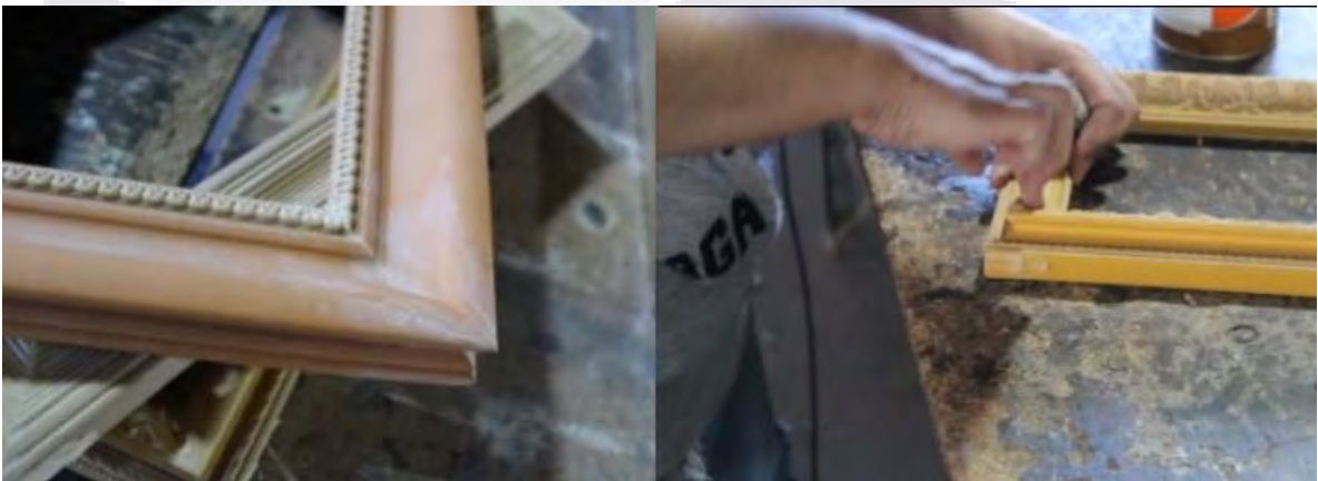
Imagen 44. Elaboración propia. (Izq.) Marco con resane en las esquinas, listo para ser lijado. (Der.) Técnico de la fábrica de cuadros y marcos en el proceso de resanado del marco, el cual se hace con los dedos.
