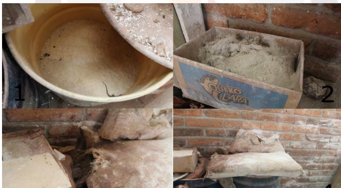
Imagen 92. Elaboración propia. Diferentes materiales que se utilizaban para la creación del campo. 1. Grenetina. 2. Tierra blanca. 3. Tierra rojiza. 4. Bultos completo donde se traían las arcillas o tierras.
