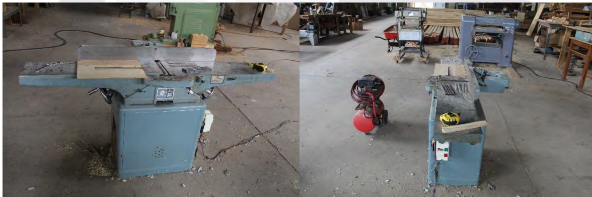
Imagen 72. Elaboración propia. Canteadora de piso, se utiliza para rebajar la madera en un lado y con esto obtener una base lineal.
