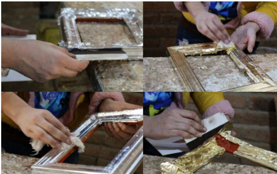
Imagen 99. Elaboración propia Arriba (Izq.) Colocación de la hoja de plata. Arriba (Der.) Después de la colocación se procede a realizar un tallado con estopa para que se adhiera de forma uniforme. Abajo (Izq.) Colocación de hoja de oro de 12 kilates. Abajo (Der.) Al igual que la colocación de hoja de plata, la de oro de 12 kilates se talla con estopa, mientras que para la de 24 kilates se realiza con una piedra para extraerle el brillo.
