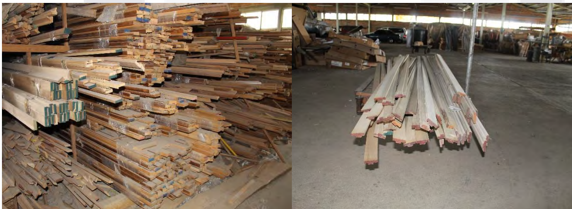
Imagen 38. Elaboración propia. (Izq.) Tiras de madera listas para para colocarlas en la molduradora y hacerles la figura. (Der.) Tiras lisas de la anchura y grosor necesarios para la crear la moldura.
