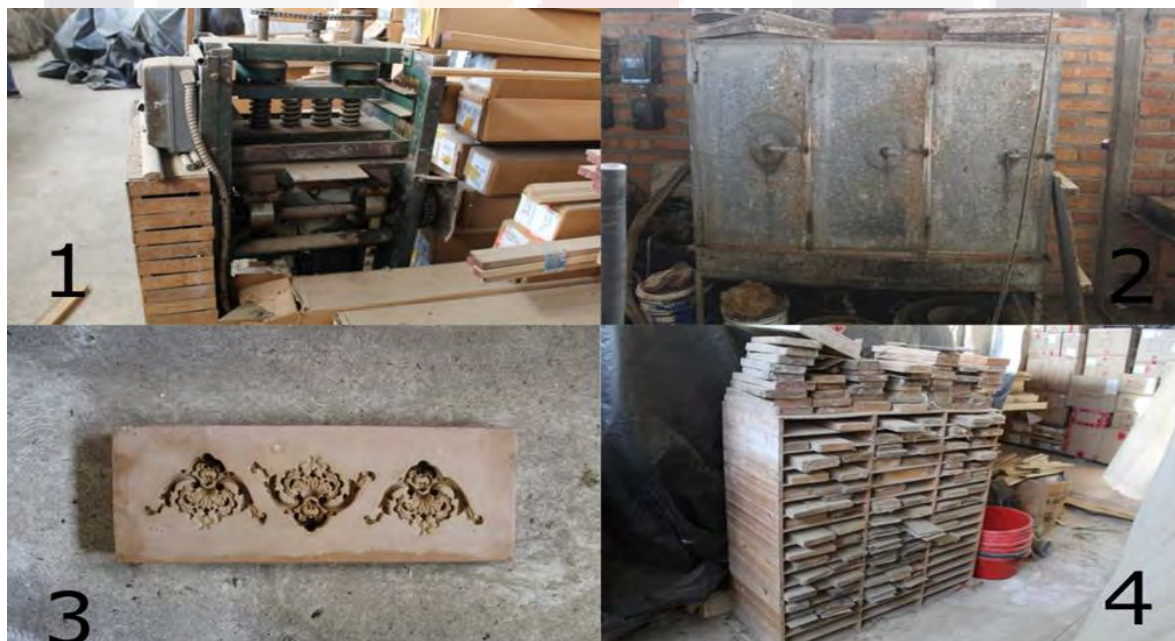
Imagen 91. Elaboración propia. Arriba (Izq.) Prensa que se utilizaba para la colocación del campo. Arriba (der.) Horno donde se cocía el campo. Abajo (Izq.) Molde o tablilla donde se colocaba la masilla y se hacía la forma requerida. Abajo (Der.) Se tienen alrededor de 100 tablillas o moldes para la creación del campo.
