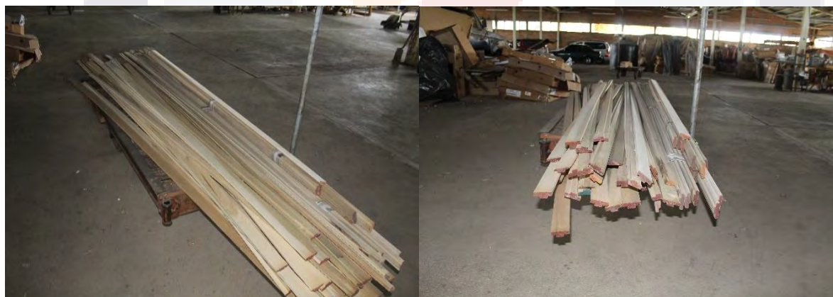
Imagen 84. Elaboración propia. Después de ser limpiada y cepillada la materia prima (madera) pasa a ser molduras.
