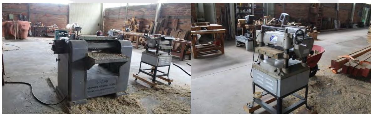
Imagen 71. Elaboración propia. Cepillo eléctrico para limpiar las tablas que serán utilizadas para molduras.
