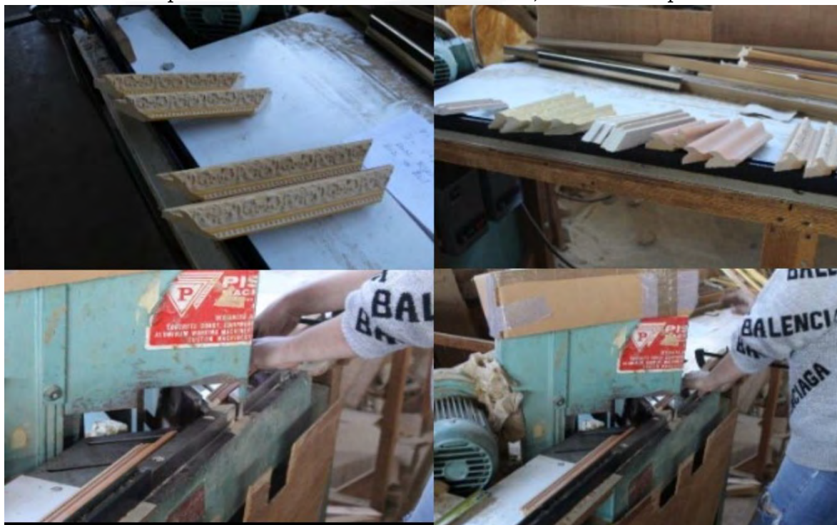
Imagen 87. Elaboración propia. Proceso de cortado de la moldura para la fabricación del marco, la cual, se realiza en varios cortes de pocas milésimas de pulgada de forma continua y con los lados paralelos para estarlos comparando con cada corte, para asegurar que sean idénticos en longitud y lograr más precisión.
