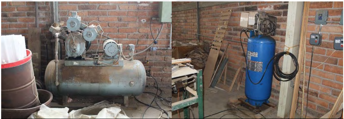
Imagen 74. Elaboración propia. Compresores de distinta marca, se utilizan para varias actividades, entre las que se encuentra: clavar, limpiar, pintar.
