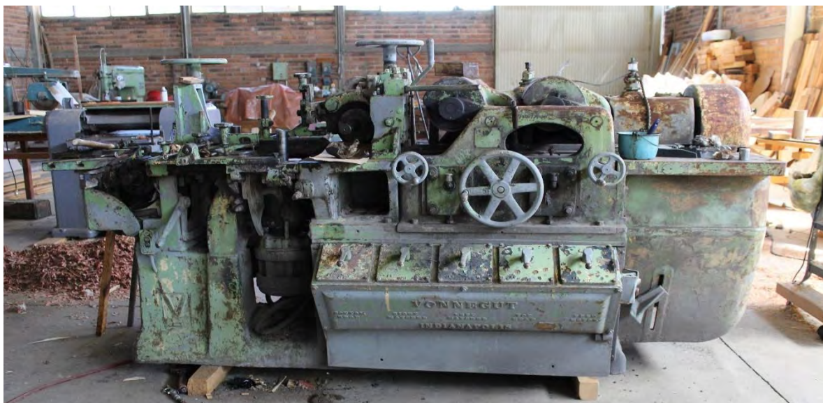
Imagen 67. Elaboración propia. Molduradora que se encuentra en la fábrica de cuadros y marcos “Monte Escobedo”, fabricada en 1919 en Indianápolis, E.U.A.
