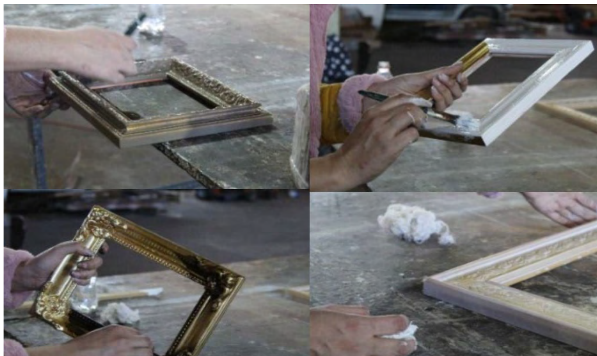
Imagen 100. Elaboración propia. Arriba (Izq.) Terminado en Oro #2, se le coloca una mancha similar a tierra o arcilla gris, posteriormente se retira el exceso o “relimpia”. Arriba (Der.) Oro F.F., a este tipo se le coloca caseína líquida y posteriormente mancha similar a tierra o arcilla gris, posteriormente se retira el exceso o “relimpia”. (Izq. Abajo) Acabado en Antique, se le coloca mancha color café oscuro, se deja secar y se retira el exceso, se hace un relimpado y se pasa con talco. Este mismo tipo de acabado se utiliza para la hoja de plata, con este mismo procedimiento. (Der. Abajo) Se le coloca caseína, pero a diferencia del oro #2, este se coloca con estopa de forma superficial, después se hace el relimpado
