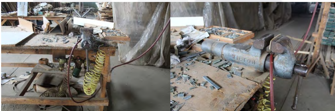
Imagen 76. Elaboración propia. Herramienta que se utiliza para armar el marco, sobre todo cuando se trata de marco de pequeño y mediano tamaño (no superior a 1.00 m.).
