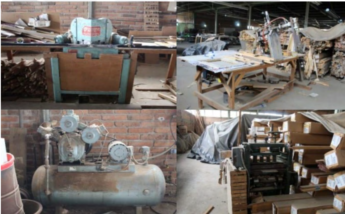
Imagen 33. Elaboración propia. Maquinas que están en la fábrica de cuadros y marcos, que funcionan y que están desde la apertura en 1979. (Arriba Izq.) Cortadora de doble disco a 45° para recortar las molduras. (Arriba Der.) Ensambladora de cuadros, la de piso funciona correctamente y la de banco no funciona. (Abajo Izq.) Compresor de aire comprimido. (Abajo Der.) Prensa utilizada para la creación del campo.
