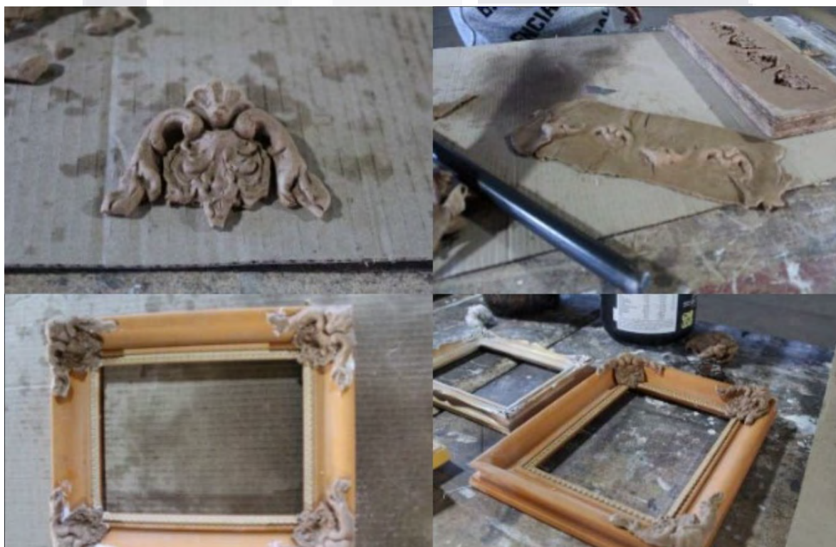
Imagen 94. Elaboración propia. Arriba (Izq.) Figura o accesorio individual campo, antes de colocar en el marco. Arriba (Der.) Proceso de fabricación, se coloca la masilla o material en los moldes y se les aplica presión con una barra para rellenar el molde y tome la figura. Abajo (Izq.) Marco completo con las cuatro esquinas con su campo. Abajo (Der.) Cuadro en proceso de colocación del campo, con tres esquinas completas y pegadas en el marco.
