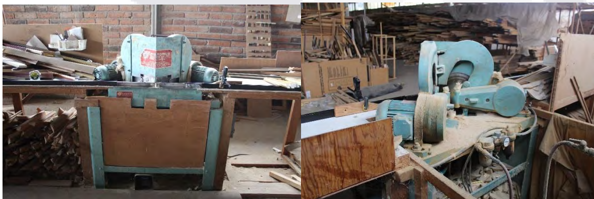
Imagen 69. Elaboración propia. Sierra eléctrica, utilizada para hacer los cortes de las molduras.
