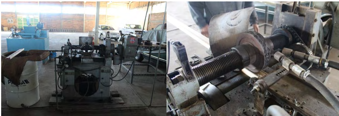
Imagen 82. Elaboración propia. (Izq.) Máquina para estampar dibujo a las molduras, similar al campo, vista de frente. (Der.) Vista de arriba de los accesorios de la máquina.
