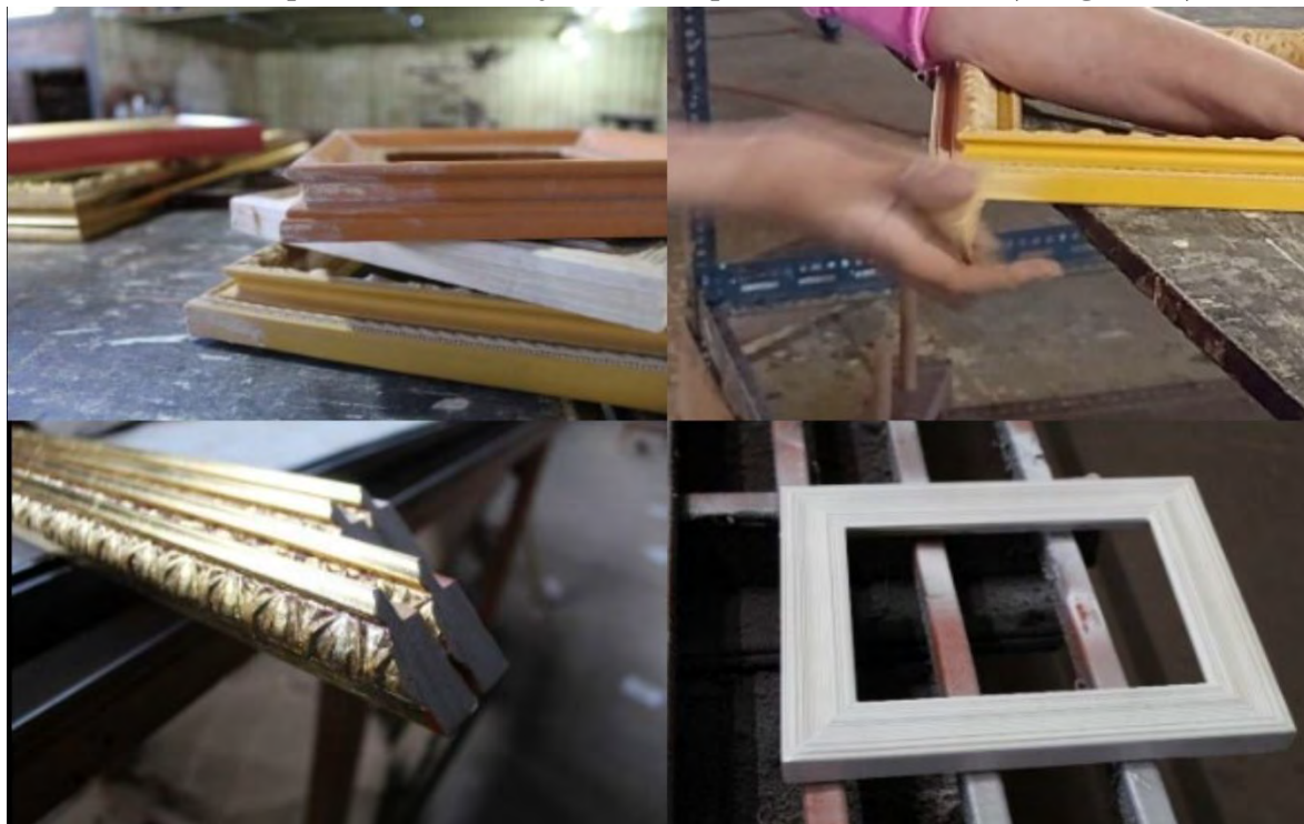
Imagen 47. Elaboración propia. (Izq. Arriba) El marco después de ser resanado, con material sobrante. (Der. Arriba) Técnico durante el procedimiento de lijado. (Izq. Abajo) Después de terminar el lijado se procede a hacer una revisión para busca de otros detalles. (Der. Abajo) Marco ya terminado de lijar, listo para iniciar con el proceso de pintado o colocación de sellador.
