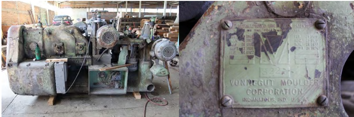
Imagen 68. Elaboración propia. (Izq.) Reverso de molduradora, adquirida por propietario en el año de 2021, la cual se le hicieron trabajos de mantenimiento general y funciona correctamente. (Der.) Placa de fabricación de la molduradora, se puede apreciar que se fabricó por la empresa Vonegut Moulder Corporation.
