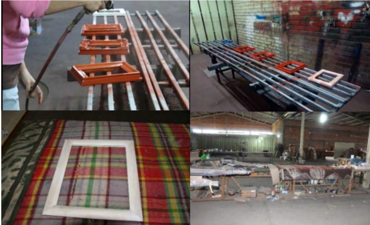
Imagen 88. Elaboración propia. (Arriba Izq.) Durante el proceso de pintura, los cuales son pintados todos los que llevan el mismo tipo de pintura o sellador al mismo tiempo. (Arriba, Der.) Cuadros terminados de colocarles sellador. (Abajo, Izq.) Marco colocado en el banco con recubrimiento de cobijas (tela) para evitar daño en el producto. (Abajo, Der.) Banco recubierto con cobijas (tela) que se utiliza para el montaje de la imagen en los marcos para terminar el proceso.
