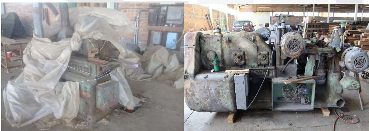
Imagen 81. Elaboración propia. Molduradora que se utilizan actualmente para realizar las molduras, las cuales pueden fabricar el dibujo en molduras de hasta 6" y 8".
