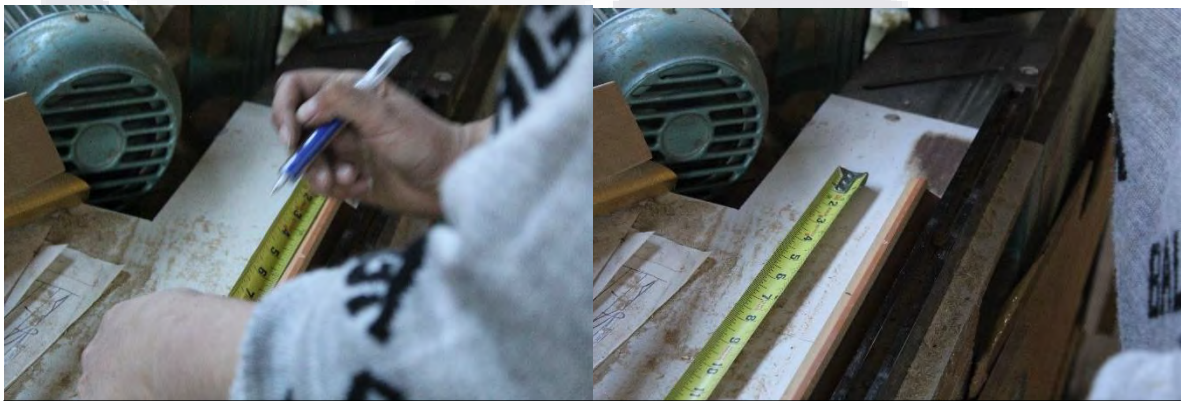
Imagen 86. Elaboración propia. Durante el proceso de corte, se realizan mediciones en las molduras para señalarla con tinta o lápiz, esta se inicia en la marca de 1" para evitar error de la uña de fijación del flexómetro. La cual se añade al total de la longitud del corte de la moldura.
