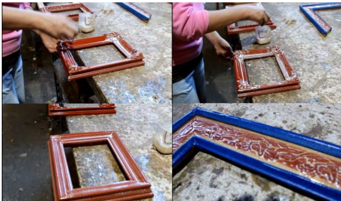
Imagen 49. Elaboración propia. (Izq. Arriba) Empleado de la fábrica, colocando mixtión en el marco. (Der. Arriba) Marco con mixtión después de colocar el sellador y color base (rojo). (Izq. Abajo) Después de colocarle mixtión se deja reposar por periodo de 24 horas como mínimo. (Der. Abajo) Se debe de repartir uniformemente en toda la superficie evitando que se hagan gotas grandes o se encharque la mixtión.
