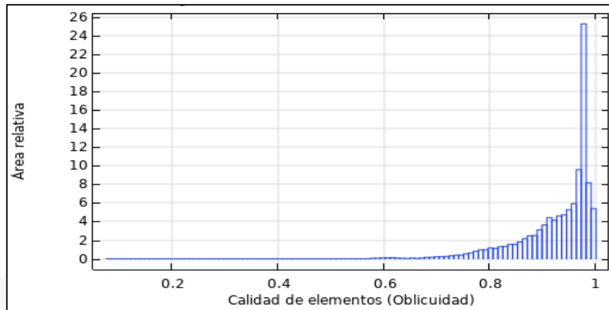
Fig. 13. Se muestra el histograma de calidad de elementos para el criterio de oblicuidad con un nivel de malla triangular libre para “plasma” puesto en la resolución “extremadamente fino”. El eje y simboliza la cantidad de área respecto al total de 204.4mm 2 . El eje x simboliza la calidad medida en escala 0 a 1. La calidad mínima de elementos fue de 0.0751 y la calidad promedio de 0.9092 [Fuente: propia].
