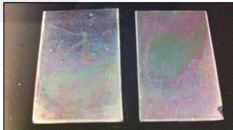
Figura 16. Catalizador de  $\text{TiO}_2\text{-Fe}^{3+}$  soportando 10 capas en vidrio a diferentes velocidades de rotación; a 2500 rpm (izquierda) y 3000 rpm (derecha). Tiempo de rotación 60 segundos.
