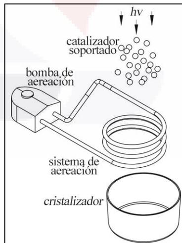
Figura 29. Esquema explosivo de prototipo de reactor fotocatalítico.
