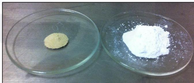
Figura 21. Muestra de un gramo de  $\text{TiO}_2\text{-Fe}^{3+}$  sintetizado por un método sol-gel (izquierda) y un gramo de P25 (derecha).
