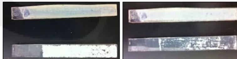
Figura 25. Catalizador P25 dopado con Fe<sup>3+</sup> (arriba) y sin dopaje (abajo) adherido a FTO antes de las pruebas de adherencia (izquierda) y después de primer prueba (derecha).
