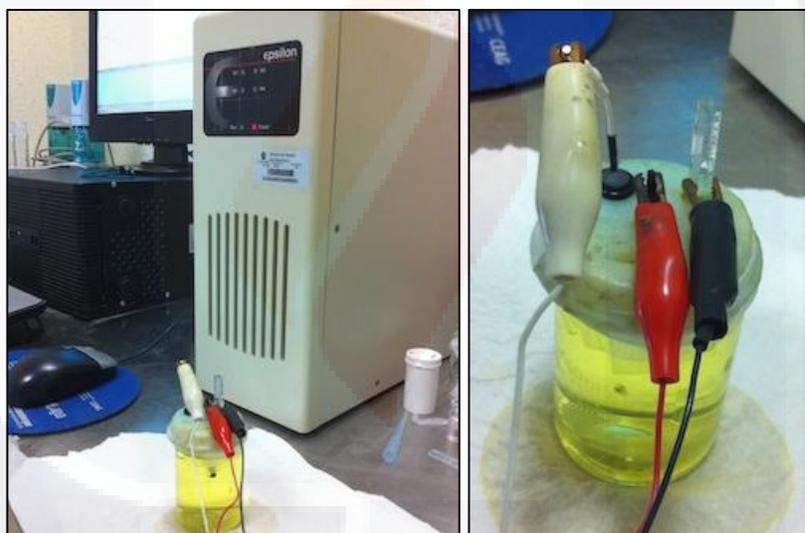
Figura 6. Potenciostato conectada a PC para análisis de datos con electrodos conectados (foto de lado izquierdo) y en la foto del lado derecho electrodos conectados a potenciostato en contacto con electrolito (solución amarilla): electrodo de trabajo (caimán negro), electrodo de referencia (caimán blanco), electrodo auxiliar (caimán rojo).
