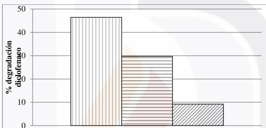
Gráfica 15. Porcentaje de degradación de DCF con distintos tratamientos fotocatalíticos. TiO<sub>2</sub>-Fe<sup>3+</sup>@FTO/Vis (verticales), TiO<sub>2</sub>@FTO/UV (horizontales), TiO<sub>2</sub>@FTO/UV/A (diagonales). pH: 4.5, t: 2 hrs, [DCF]: 20 ppm.
