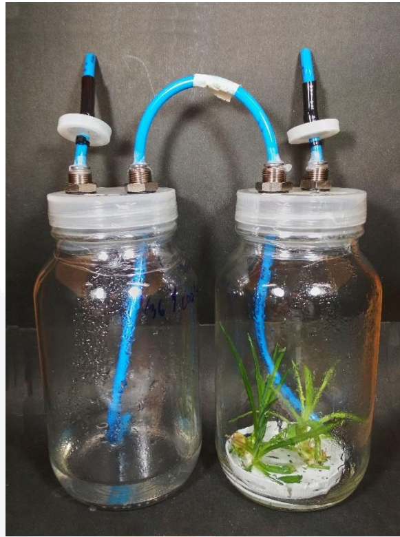
Figura 2. Esquema de construcción de biorreactor de inmersión temporal.
