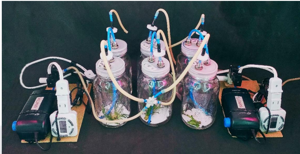
Figura 4. Diseño propio escalado de biorreactores de inmersión temporal.
