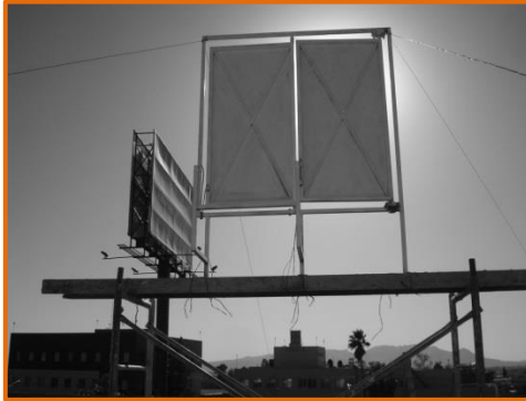
Imagen 26, fotografía de a propuesta montada para superar los 10 m de altura. Fuente propia.
