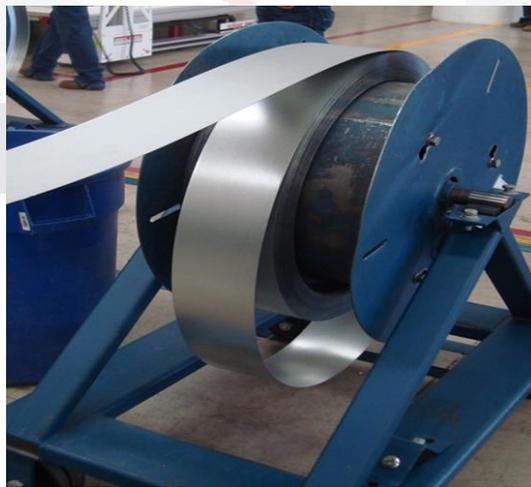
**Figura 9: Cinta de acero galvanizado G60**
