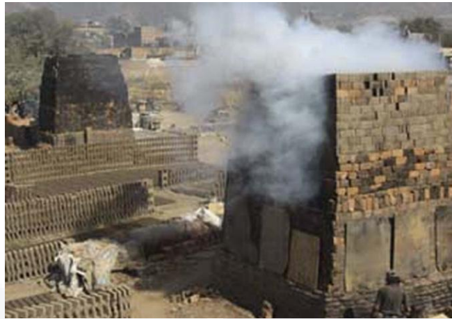
Figura 29. Horno tradicional abierto. Fuente: http://ladobe.com.mx/2011/10/la-produccion-de-ladrillo-entre-la-tradicion-y-la-rentabilidad/
