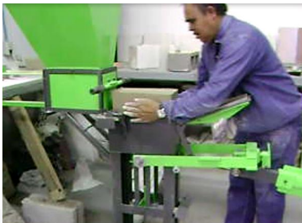
Figura 24. Obtención del bloque compactado.
