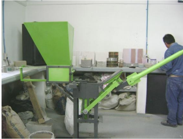
Figura 16. Vista de la máquina manual TA-100 para fabricar bloques de tierra compactada en la planta Calidra.
