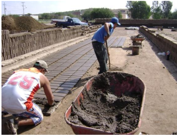
Figura 37. Proceso de moldeado.
