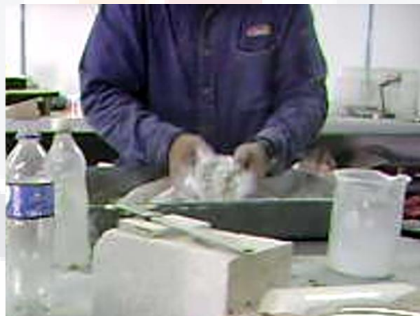
Figura 19. Mezclado en seco del tepetate y la cal.
