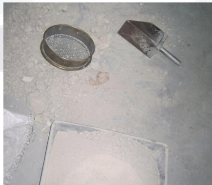
Figura 17. Herramientas utilizadas para el tamizado del material obtenido para la fabricación de BTC.
