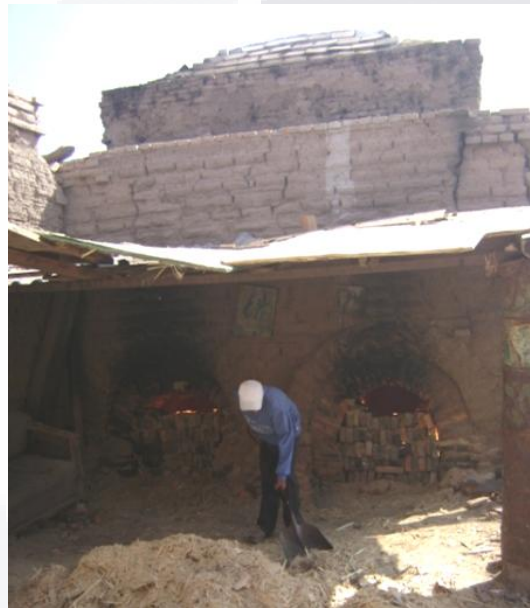
Figura 42. Vista del horno fijo y uso de aserrín como combustible.
