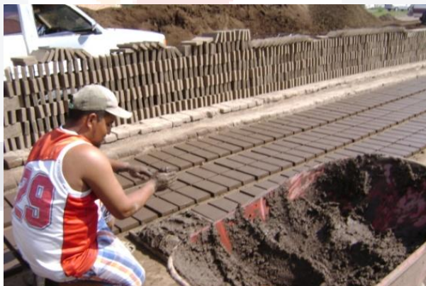
Figura 38. Tabiques recién moldeados.
