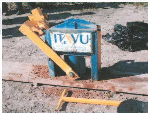
Figura 7. Máquina bloquera del ITAVU, basada en la CINVA RAM. Fuente: Cicero, 2008
