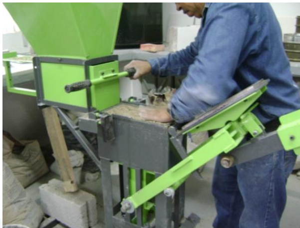
Figura 22. Proceso de acomodo de la tierra en el molde de la máquina.
