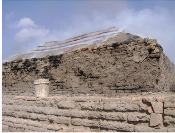
Figura 44. Parte superior del horno fijo durante el proceso de cocción.
