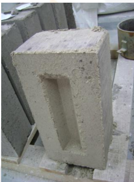
Figura 25. Vista del bloque terminado.
