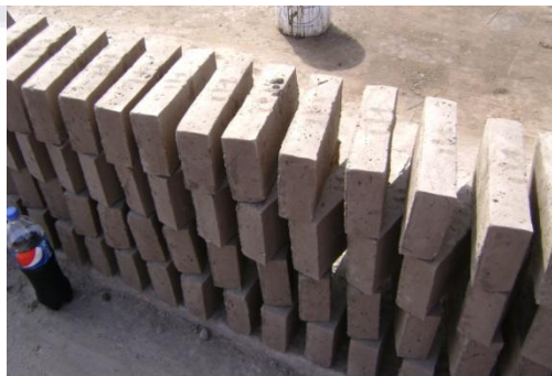
Figura 41. Tabiques en proceso de secado.
