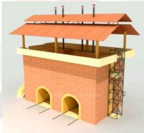
Figura 31. Horno de eje vertical (VSBK). Fuente: http://ladrillo.wordpress.com/category/tecnica/
