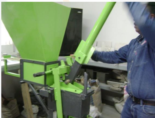
Figura 23. Proceso de prensado manual.
