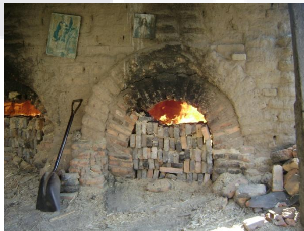
Figura 43. Proceso de cocción en horno fijo de ladrillera.
