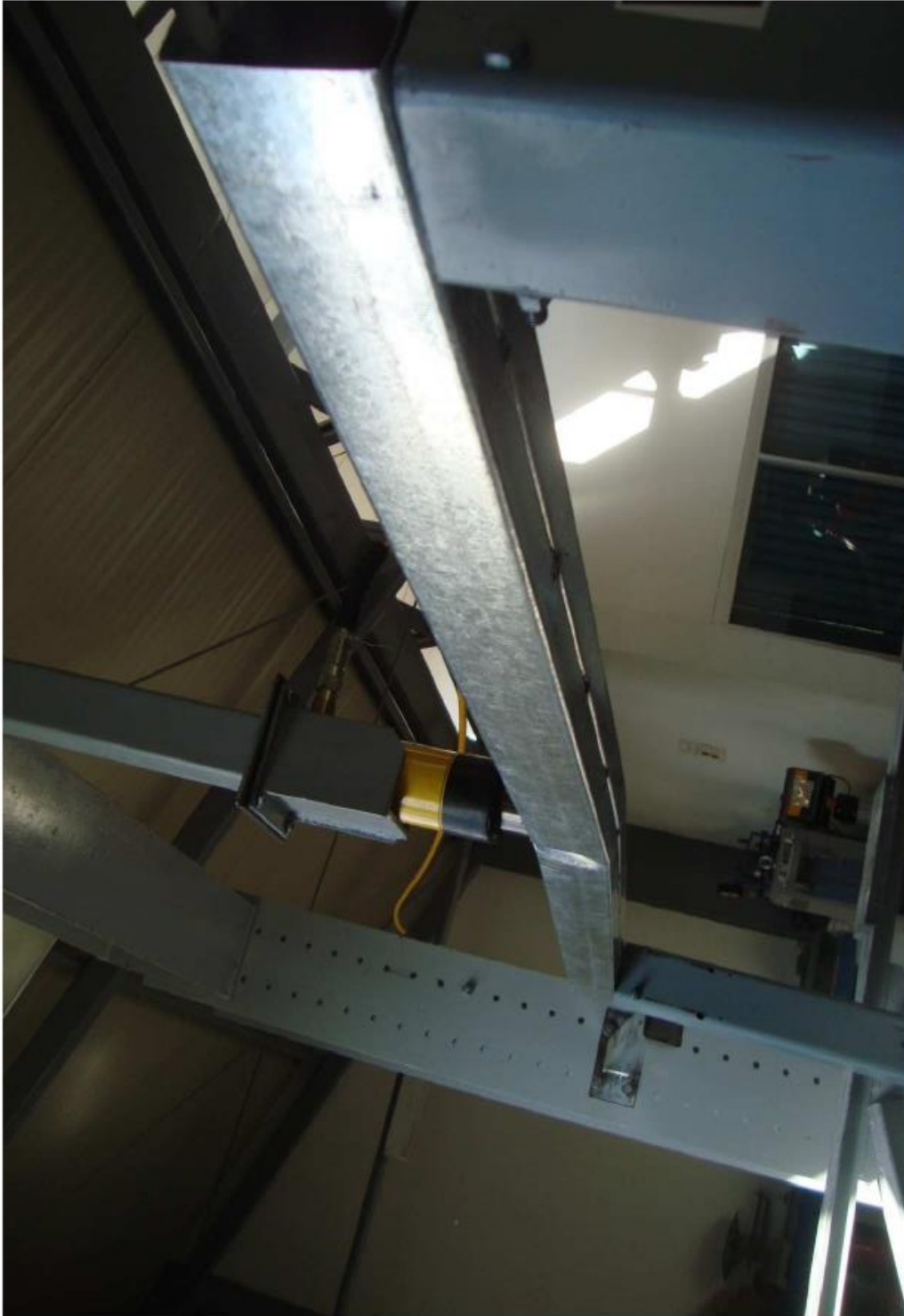
ENSAYO DE PERFIL SECCION CAJON EN LABORATORIO
