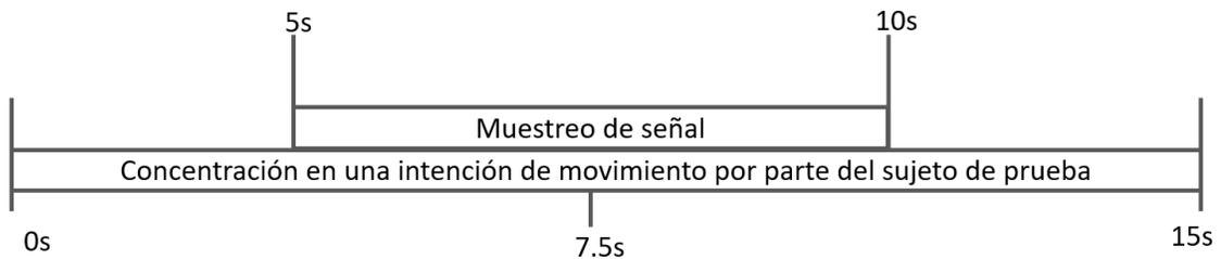
**Figura 63.** Protocolo de captura de señales EEG-MI aplicado en el modelo MHH-FSS-RNA.
