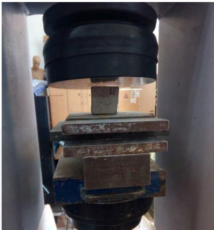
Figura 40. Ensayo a compresión, Elaboración propia, archivo del autor.
