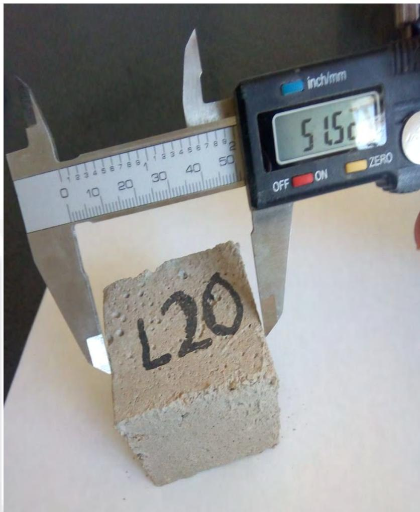
Figura 36. medición de probetas, Elaboración propia, archivo del autor
