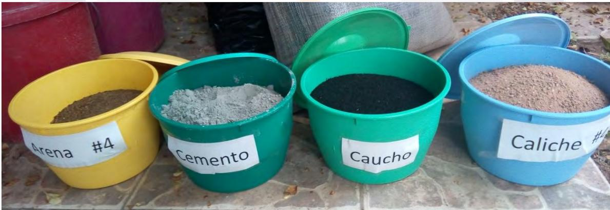
Figura 18. Materiales para la elaboración de mezclas para fabricación de probetas, Elaboración propia, archivo del autor
