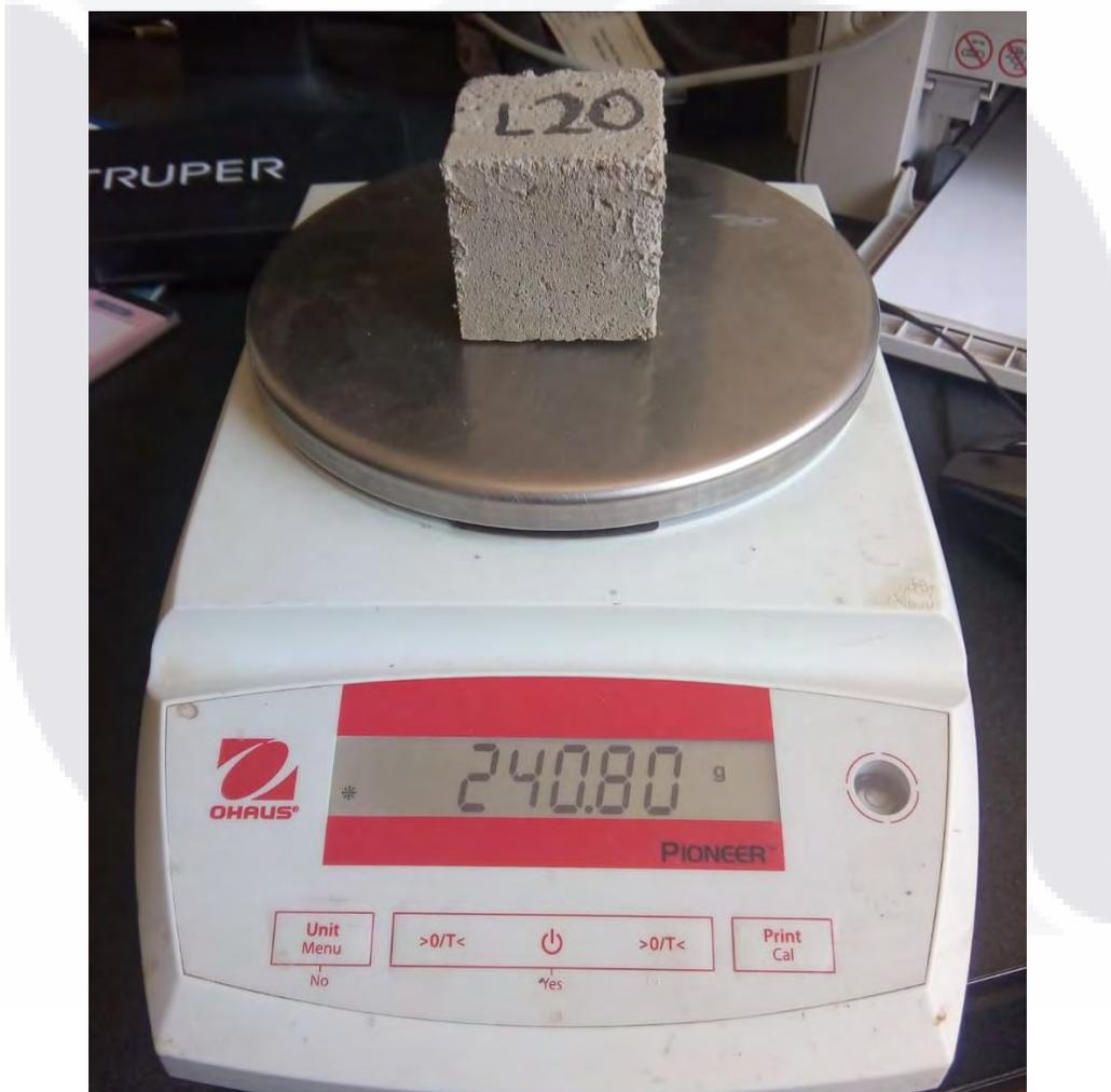
Figura 35. Pesado de probetas Elaboración propia, archivo del autor
