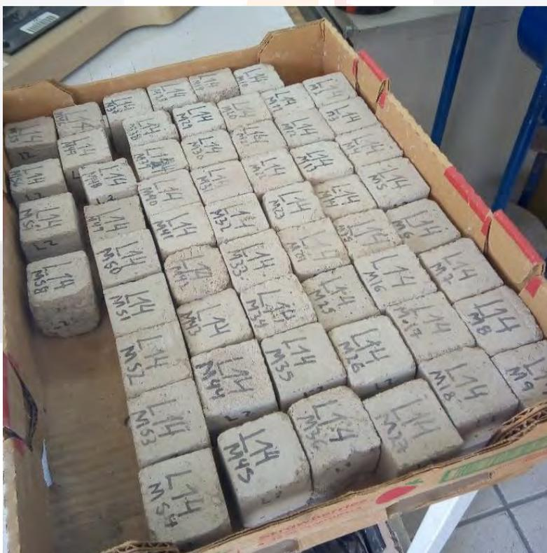
Figura 34. Probetas 5 cm por lado clasificadas, Elaboración propia, archivo del autor
