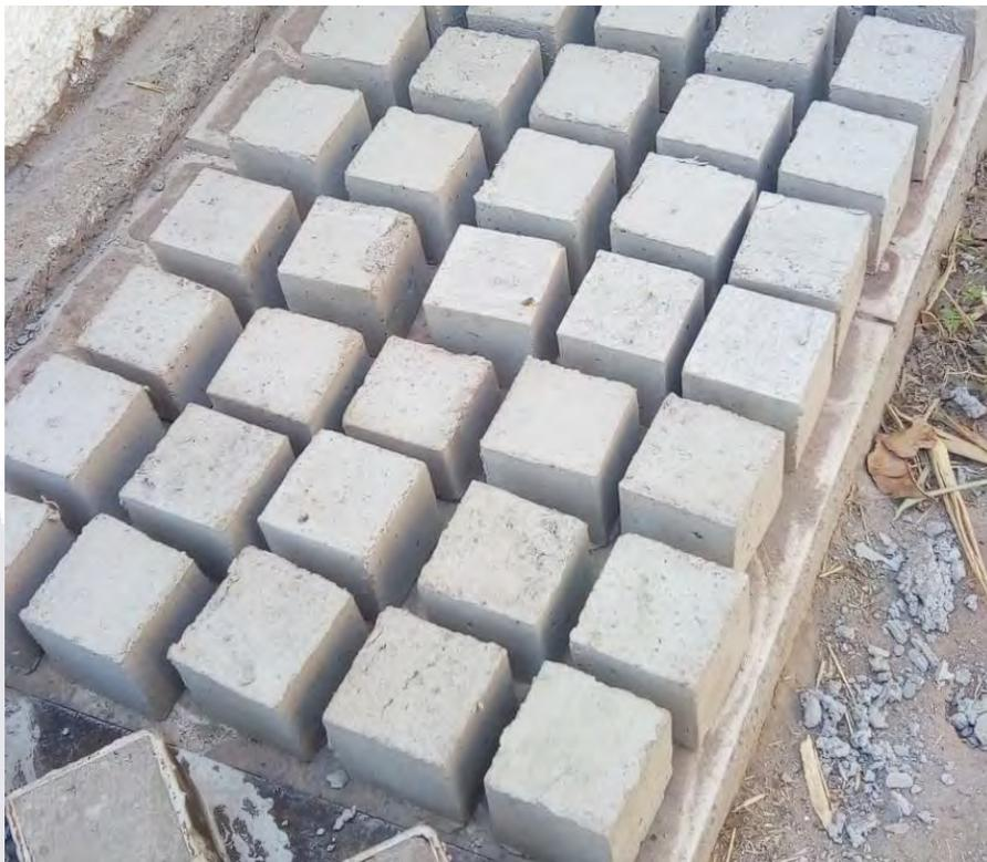
Figura 31. Probeta 5 cm por lado, Elaboración propia, archivo del autor
