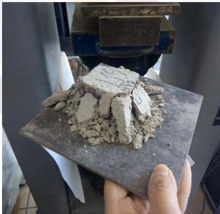
Figura 41. Probeta sometida a ensayo de compresión, Elaboración propia, archivo del autor.
