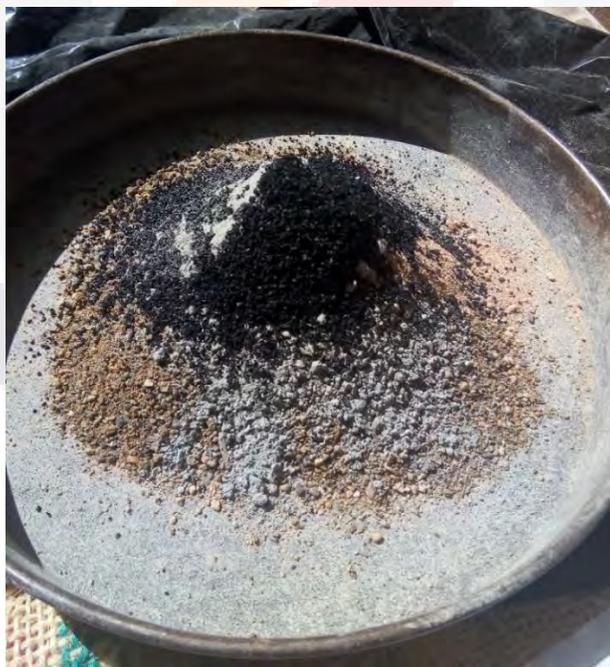
Figura 23. Incorporación de cemento y caucho a la mezcla, Elaboración propia, archivo del autor
