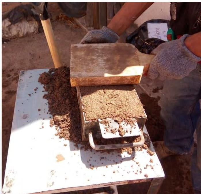
Figura 27. Elaboración de probetas 7 cm, 14 cm, 28 cm, Elaboración propia, archivo del autor
