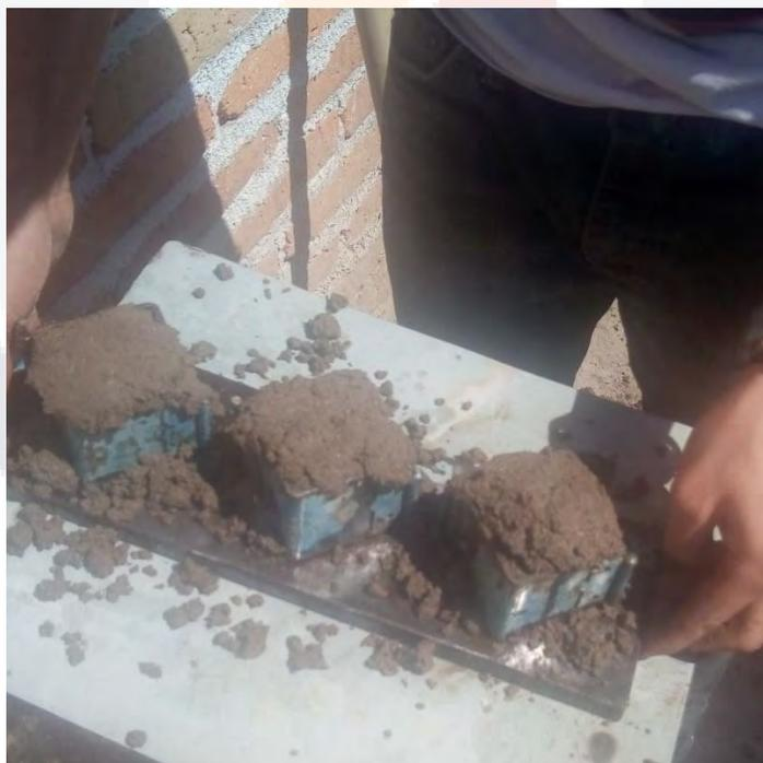
Figura 28. Elaboración de probetas 5cm por lado, Elaboración propia, archivo del autor
