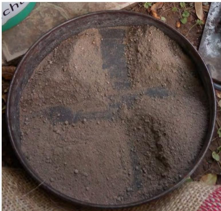
Figura 22. Homogenización de materiales por técnica de cuarteo, Elaboración propia, archivo del autor
