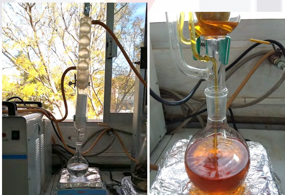
Figura 4. Equipo Soxhlet en funcionamiento*En la imagen de la izquierda se muestra antes del reflujo y en la parte derecha después.
