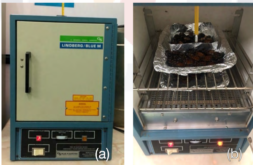
Figura 16. (a) Horno secador. (b) Charolas con cucarachas troceadas secándose
