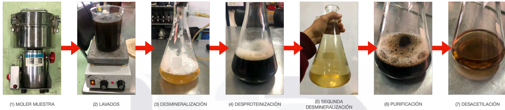
Figura 21. Imágenes representativas de cada una de las 7 etapas en la producción de quitosano. (a) Molino pulverizador utilizado. (2) Lavado de harina de cucaracha con agitación. (3) Disolución con extracción de minerales. (4) Disolución con extracción de proteínas. (5) Disolución con extracción de minerales en reproceso. (6) Disolución con extracción de carbonato de calcio y proteínas residuales. (7) Disolución resultante de proceso de desacetilación
