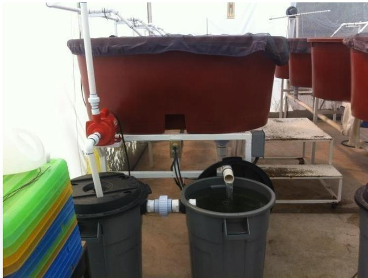
**Figura 6. Sistema cerrado de recirculación.**
