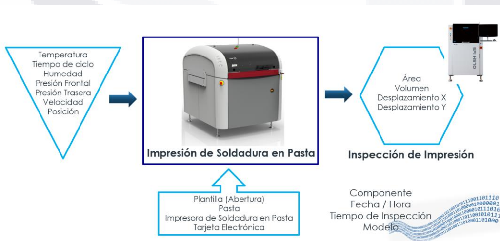
Figura 26. Esquema general del proceso de impresión de pasta e Inspección. Elaboración Propia.
