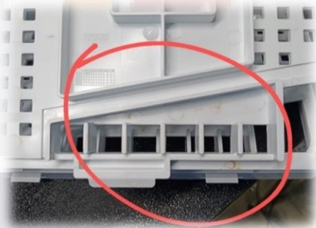
Figura 9. Grasa en la pieza plástica.
