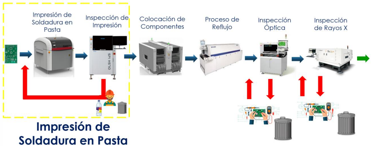
Figura 25. Tecnología de Montaje Superficial: Impresión de pasta e inspección. Elaboración Propia.
