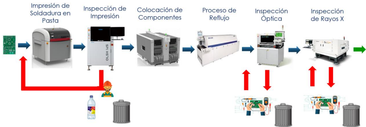
Figura 18. Proceso general de Tecnología de Montaje Superficial. Elaboración Propia.
