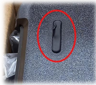
Figura 15. Malformación en la pieza.
