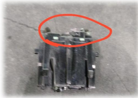
Figura 13. Faltante de plástico.
