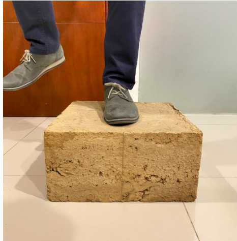
Imagen No. 22 Resistencia del casetón con carga de una persona adulta con peso de 74 kg.
