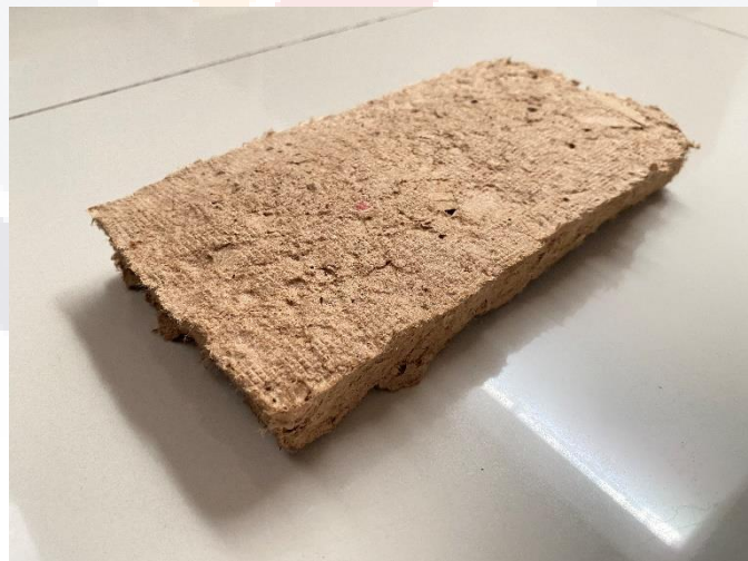
Imagen No. 5 Probeta una vez seca y retirada del bastidor de madera
