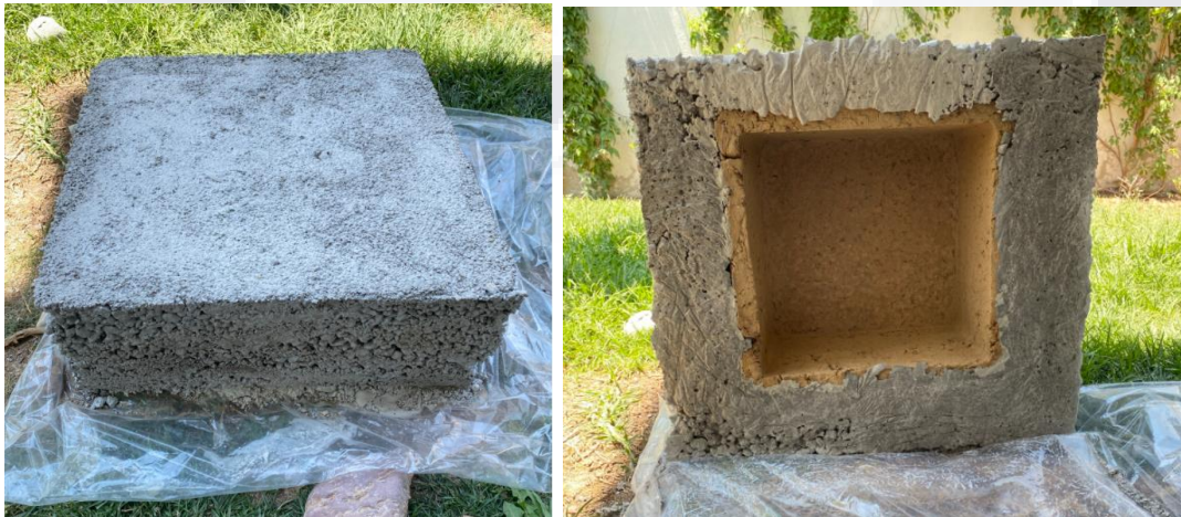
Imagen No. 25 Concreto con retiro de cimbra después de siete días
