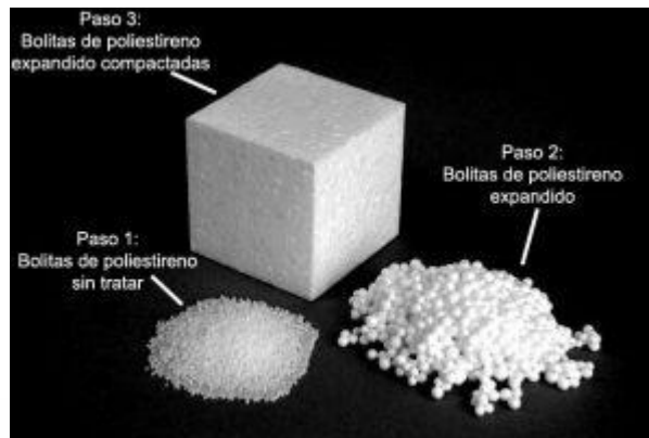
Figura No. 6 Composición del poliestireno expandido EPS
