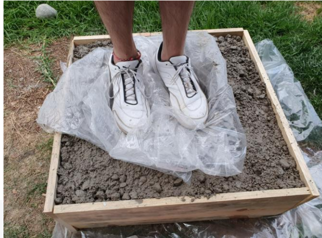
Imagen No. 24 Concreto con carga adicional de una persona simulando una situación real
