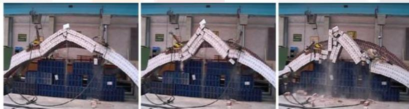
**Figura 54:** Fallo iniciado por la separación entre las roscas de la bóveda y seguido por la formación de un mecanismo monoarco (Niño, 2007).
