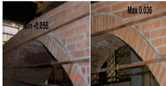
**Figura 73:** Mecanismo de Falla del Modelo Experimental (Unidades: m)
