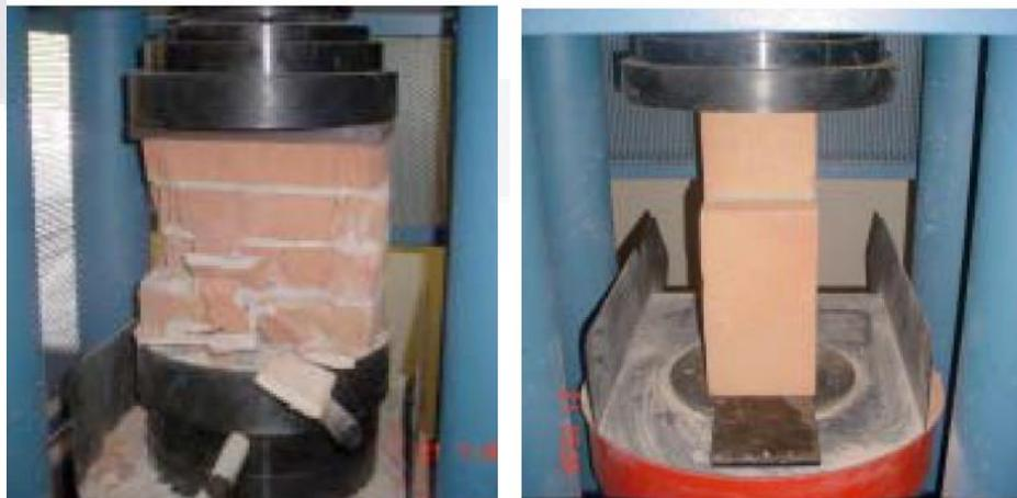
**Figura 64:** Probetas ensayadas a compresión y cortante (Castiblanque, 2003).
