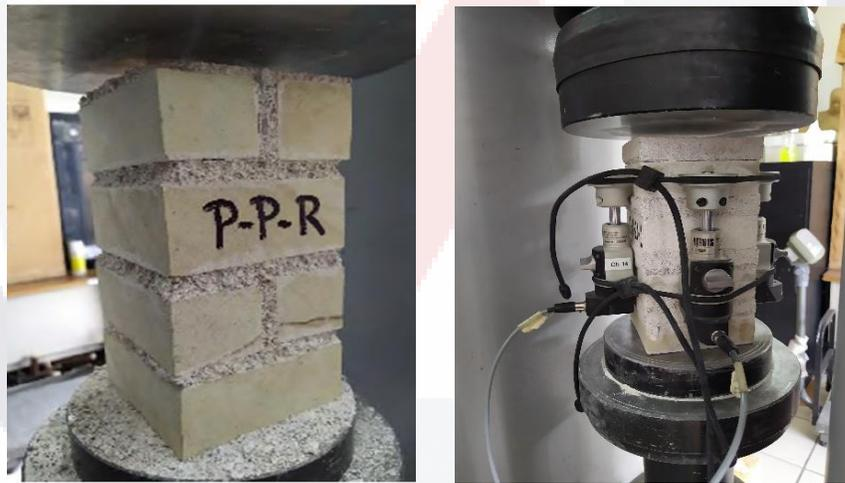
**Figura 76:** Ensayos a compresión uniaxial realizados por el Ingeniero Miguel Ángel Flores Olivares para determinar las propiedades mecánicas de la mampostería (Olivares, 2021).
