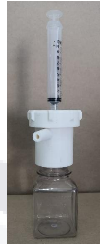
Figura 23. Visualización del dispositivo de filtración. Se observa como da soporte a la jeringa que ya cuenta con su filtro y está lista para el proceso de filtrado.
