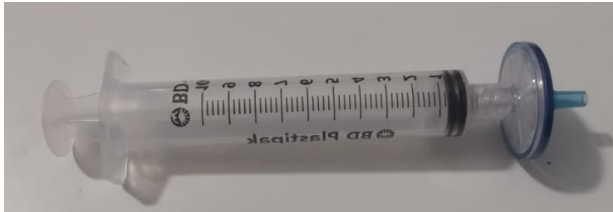
Figura 22. Visualización de la jeringa y el filtro desechable, unidos por el sistema de rosca o cuerda.
